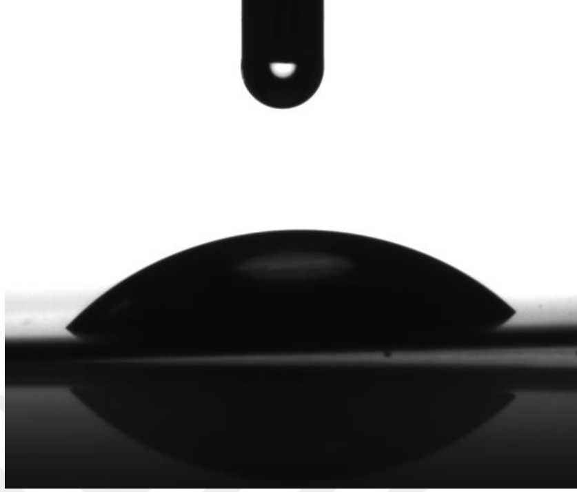
Şekil 5.126. 50V 10 dakika uygulanarak hazırlanan nano pürüzlü yüzeyin temas açısı ölçüm görüntüsü.
