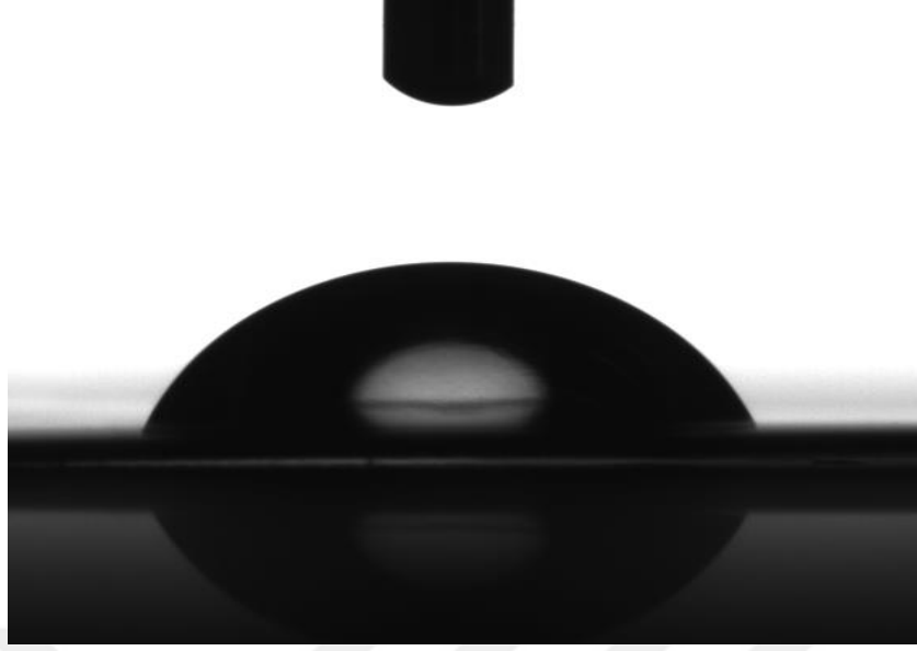
Şekil 5.124. 10V 10 dakika uygulanarak hazırlanan nano pürüzlü yüzeyin temas açısı ölçüm görüntüsü.
