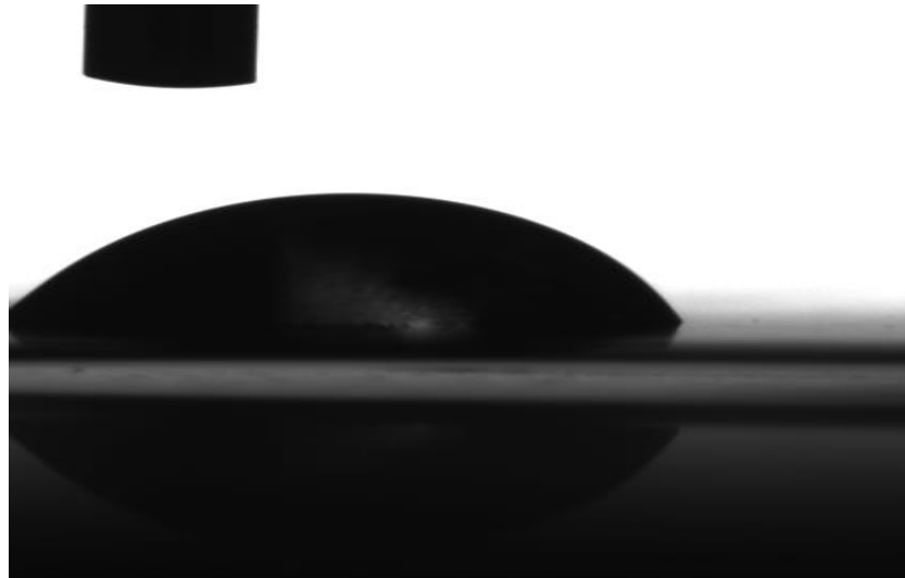
Şekil 5.129. Nanotüp yüzeyin temas açısı ölçüm görüntüsü.
