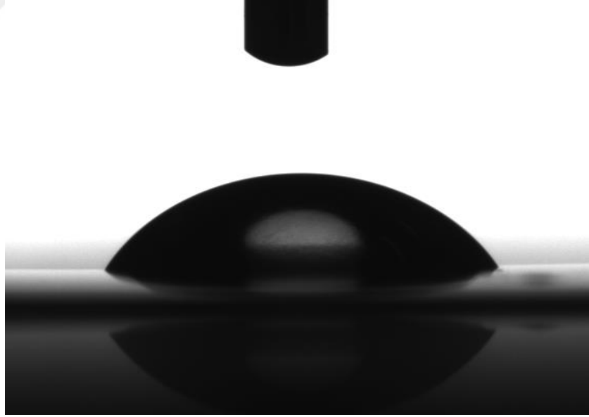
Şekil 5.125. 10V 45 dakika uygulanarak hazırlanan nano pürüzlü yüzeyin temas açısı ölçüm görüntüsü.
