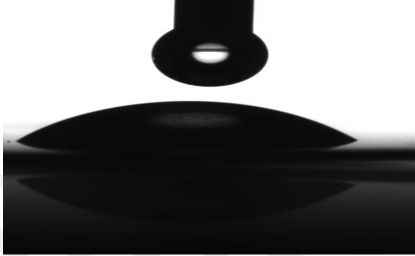
Şekil 5.128. Nano tanecikli yüzeyin temas açısı ölçüm görüntüsü.
