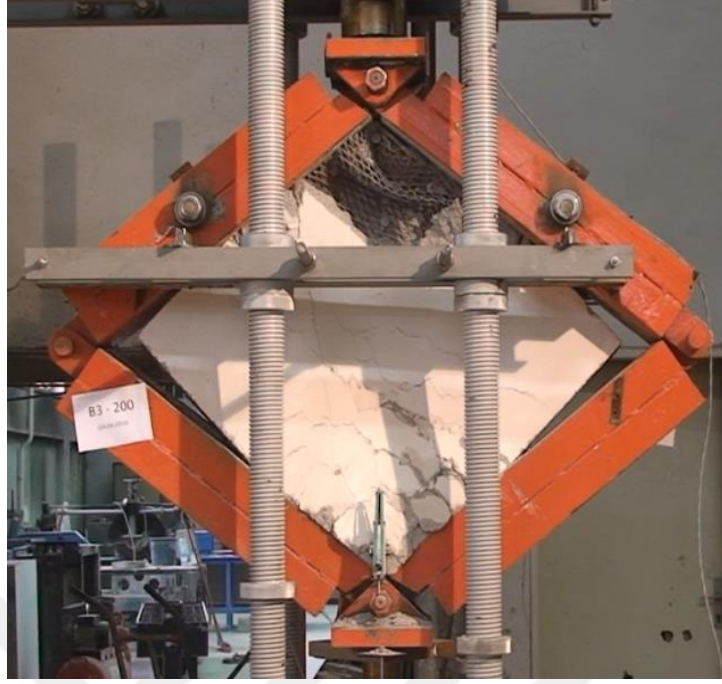
Resim 4.24. B3,0-200 elemanın deney sonu hasar durumu
