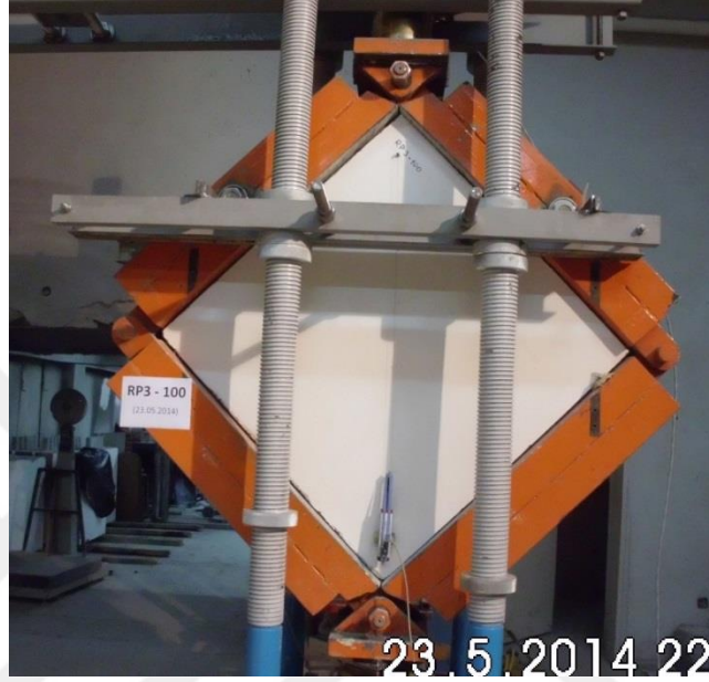
Resim 4.37. RP3,0-100 elemanın deneyden nceki durumu
