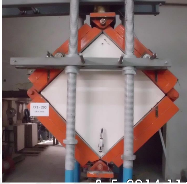
Resim 4.35. RP2,0-200 elemanın deneyden nceki durumu
