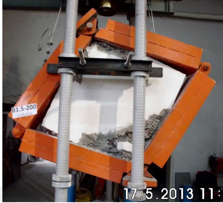
Resim 4.10. B1,5-200 elemanının deney sonu hasar durumu
