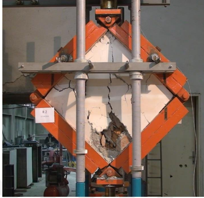
Resim 4.4. R2 elemanın deney sonu hasar durumu
