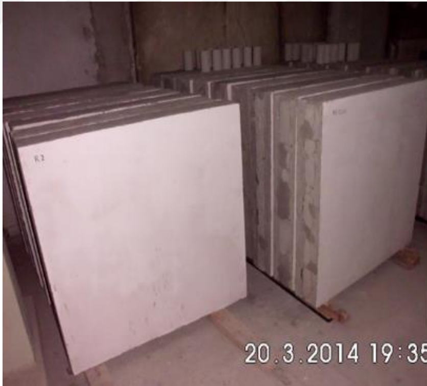
Resim 3.5. Deney elemanlarının yapım aşamasında alçı çekilmesi
