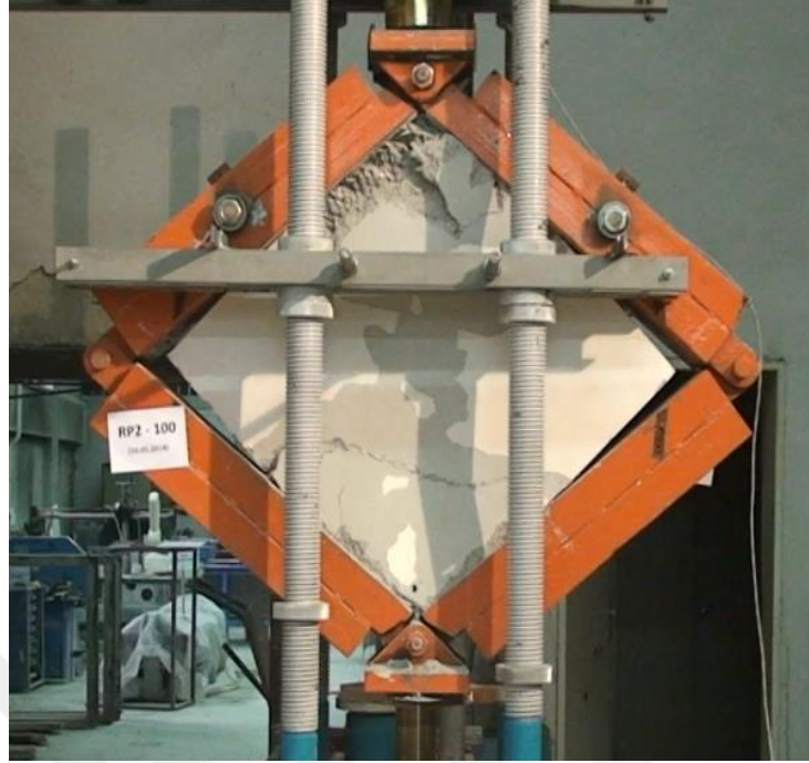
Resim 4.32. RP2,0-100 elemanın deney sonu hasar durumu
