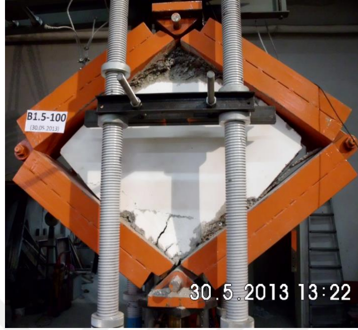
Resim 4.6. B1,5-100 elemanının deney sonu hasar durumu
