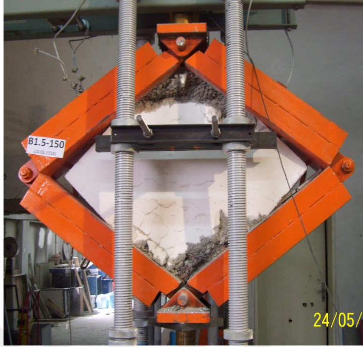
Resim 4.8. B1,5-150 elemanın deney sonu hasar durumu
