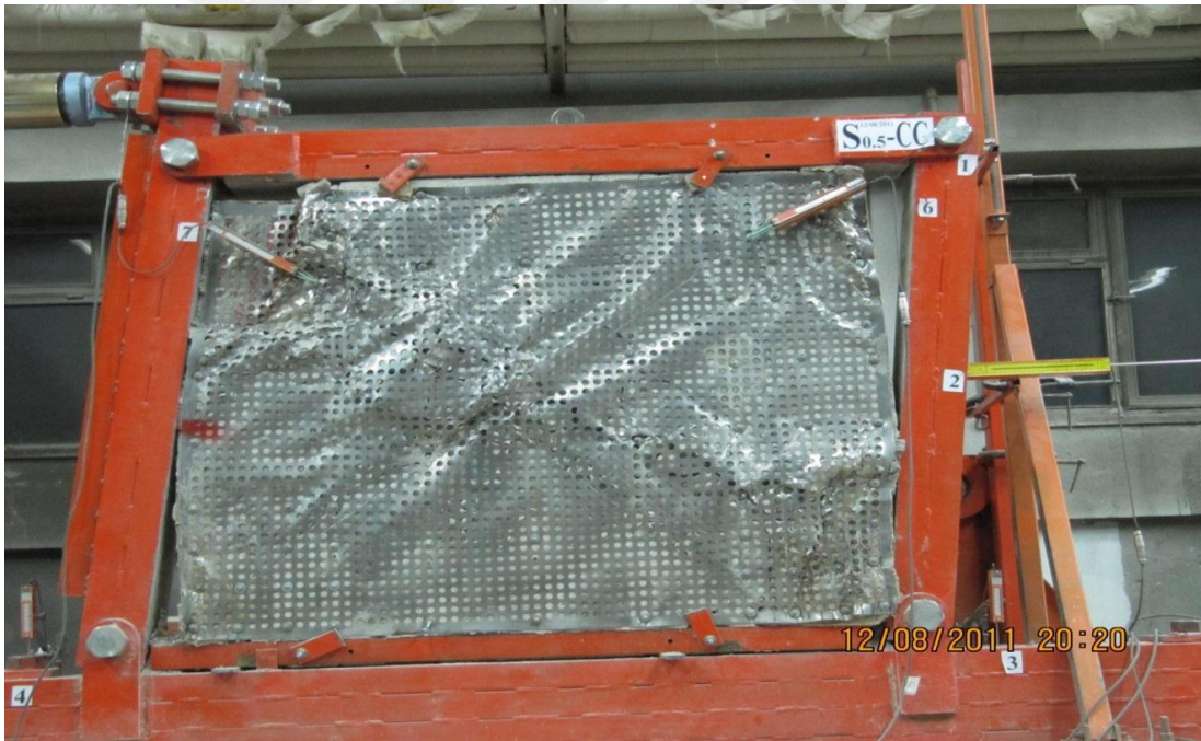
Resim 2.2. Babayani'nin (2012) çalışmasında S0,5-CC deney elemanının deney sonu hasar durumu
