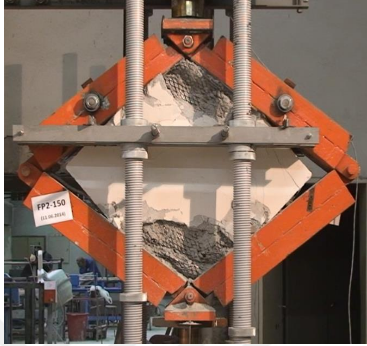
Resim 4.52. FP2,0-150 elemanın deney sonu hasar durumu
