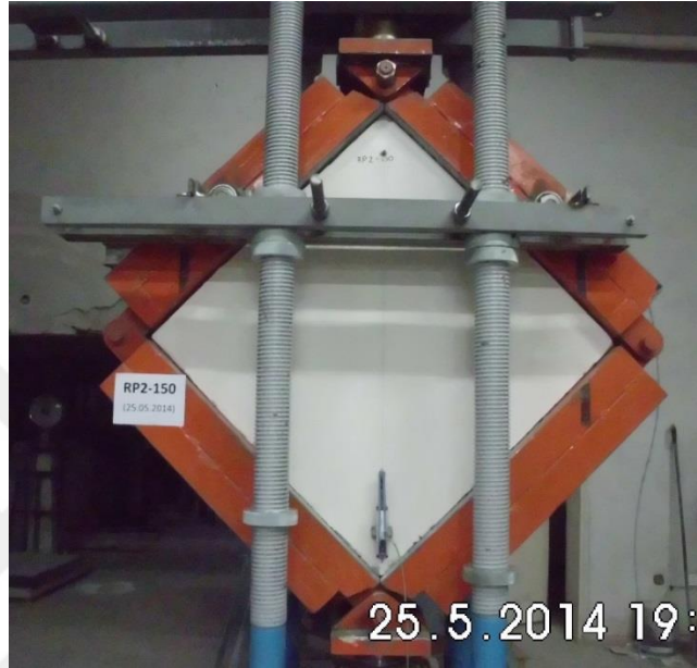
Resim 4.33. RP2,0-150 elemanın deneyden nceki durumu
