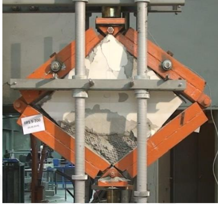
Resim 4.30. RP1,5-200 elemanın yük-deplasman eğrisi ve deney sonu hasar durumu
