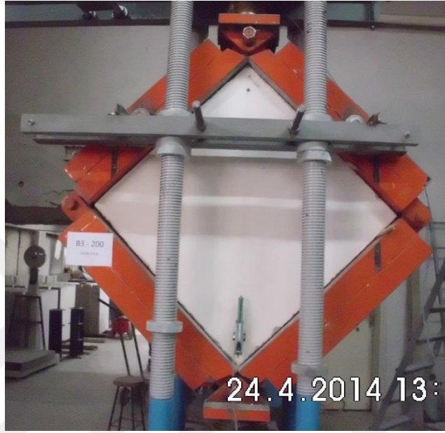
Resim 4.23. B3,0-200 elemanın deneyden nceki durumu
