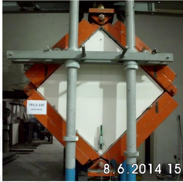
Resim 4.45. FP1,5-150 elemanın deneyden önceki durumu
