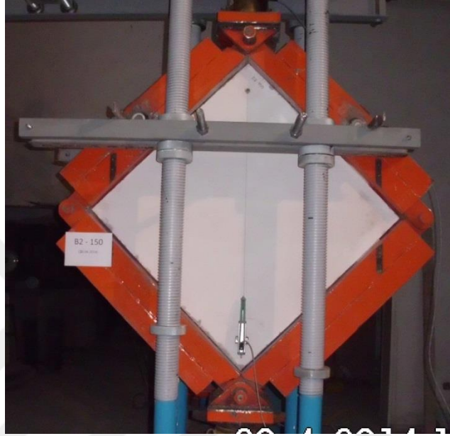
Resim 4.15. B2,0-150 elemanın deneyden nceki durumu
