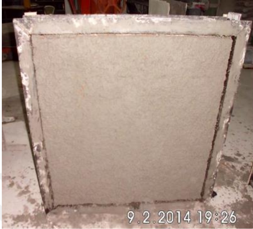
Resim 3.4. Deney elemanlarının yapım aşamasında sıvanması
