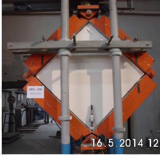
Resim 4.39. RP3,0-150 elemanın deneyden nceki durumu
