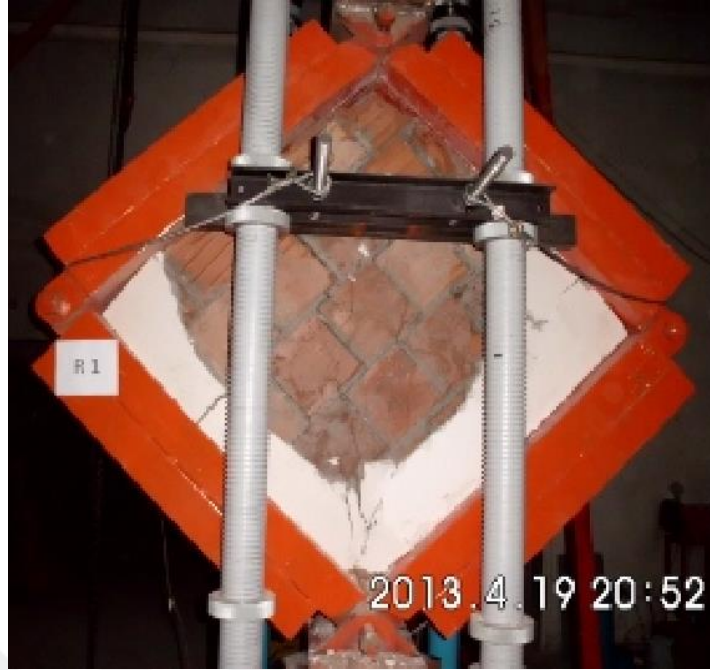
Resim 4.2. R1 elemanın deney sonu hasar durumu
