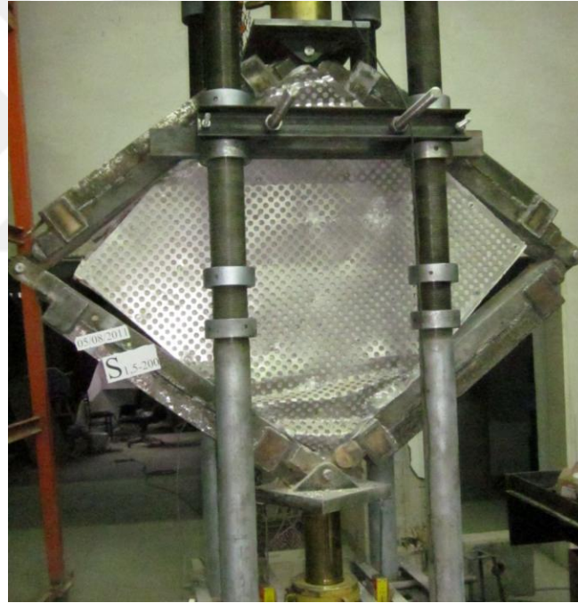
Resim 2.1. Seydanhoğlu'nun (2013) çalışmasında S1.5-200 deney elemanının deney sonundaki hasar durumu
