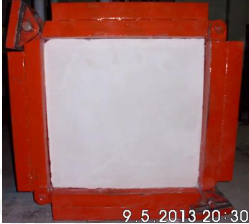
Resim 3.6. Deney elemanlarının yapım aşamasında çerçeveye yerleştirilmesi
