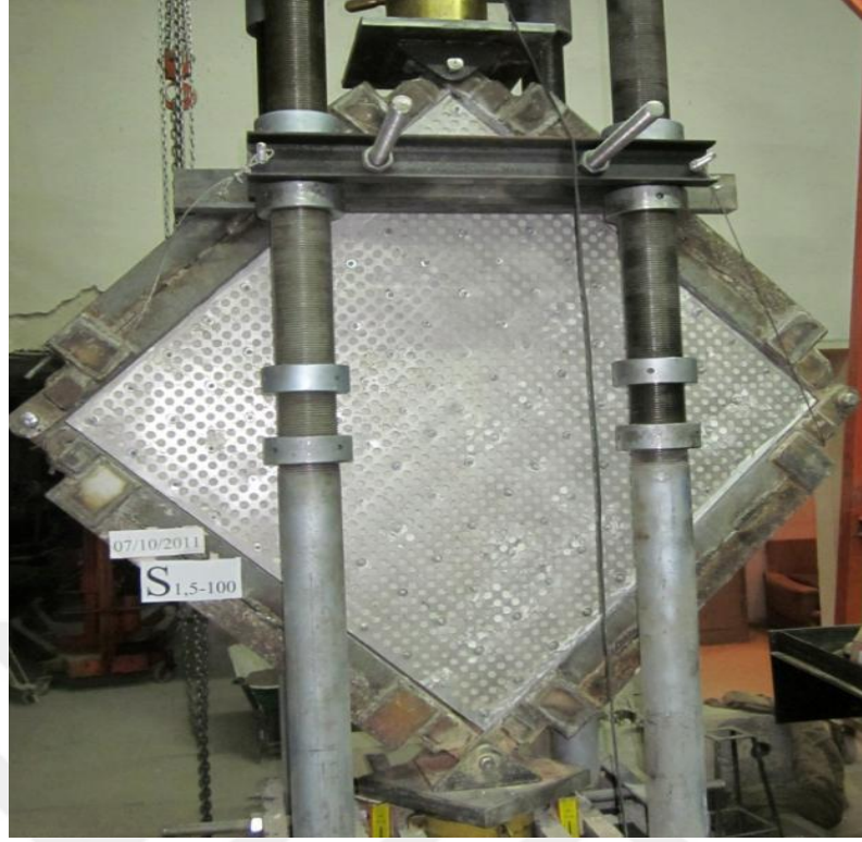
Resim 5.5. Delikli sac levhalar kullanılarak güçlendirilen S1,5-100 elemanın deney öncesi durumu (Seydanlıođlu ,2013)
