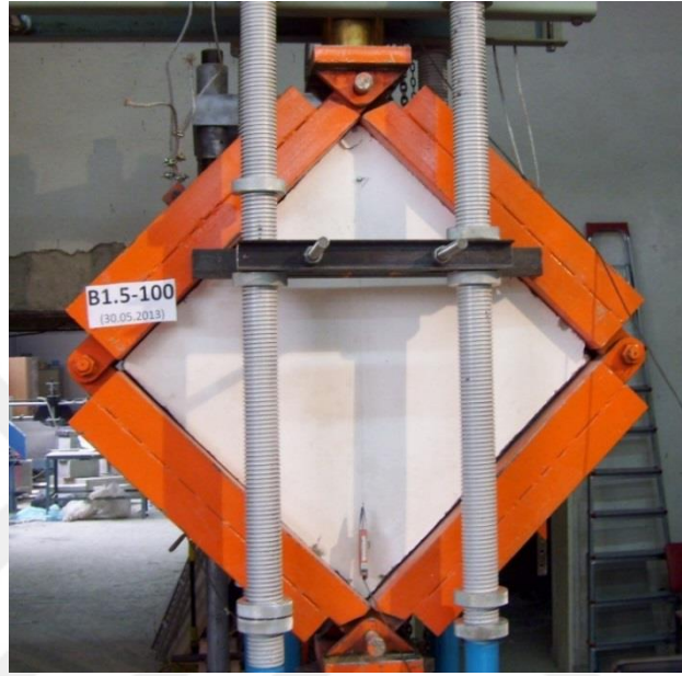
Resim 4.5. B1,5-100 elemanın deneyden nceki durumu
