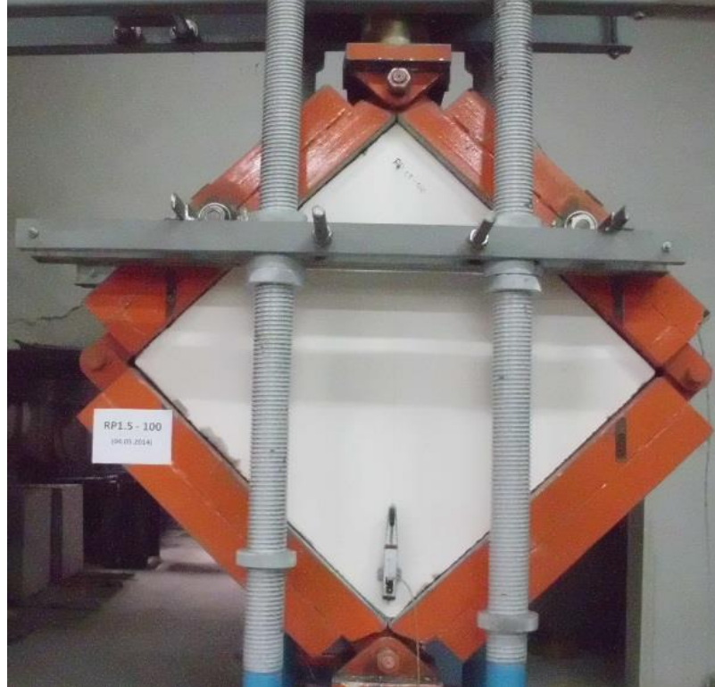
Resim 5.6. Geniřletilmiř çelik levhalar kullanılarak güçlendirilen RP1,5-100 elemanın deney öncesi durumu
