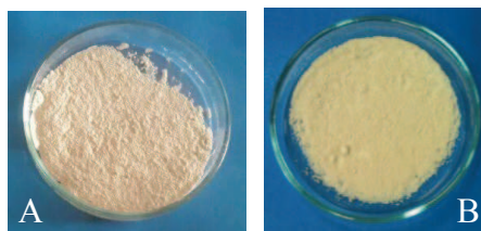
Şekil 8.74. AgHAP-SP70(0,46) numunesine ait genel görünüm A) oda sıcaklığında, B) 105 °C
