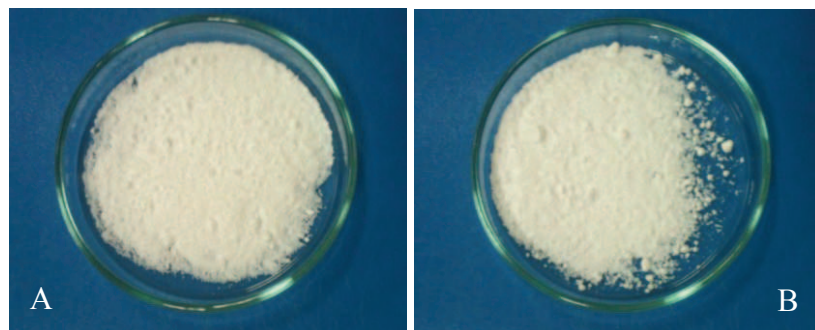
Şekil 8.49. Üretilen hidroksiapatit toza ait genel görünüm A) HAP-SP70, B) HAP-SPK70
