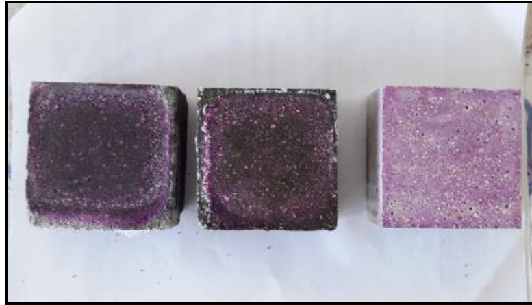
Şekil 4.43. Fenolftalein püskürtülmüş numuneler
