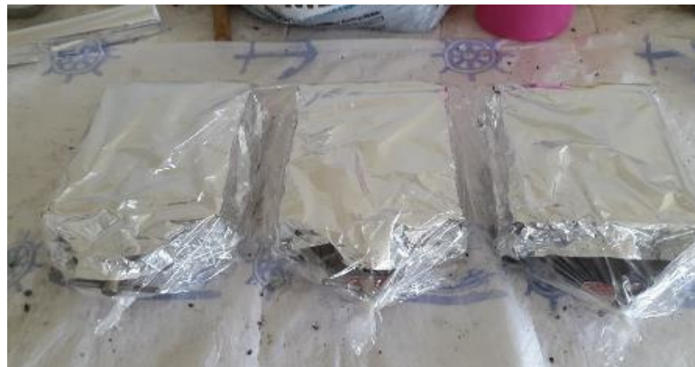
Şekil 4.25. Yanmaz fırın poşeti ile sarılan numuneler
