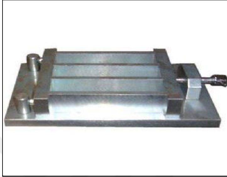
Şekil 4.18. TS-EN 196-1 'e uygun 40x40x160 mm boyutlarında prizma kalıp
