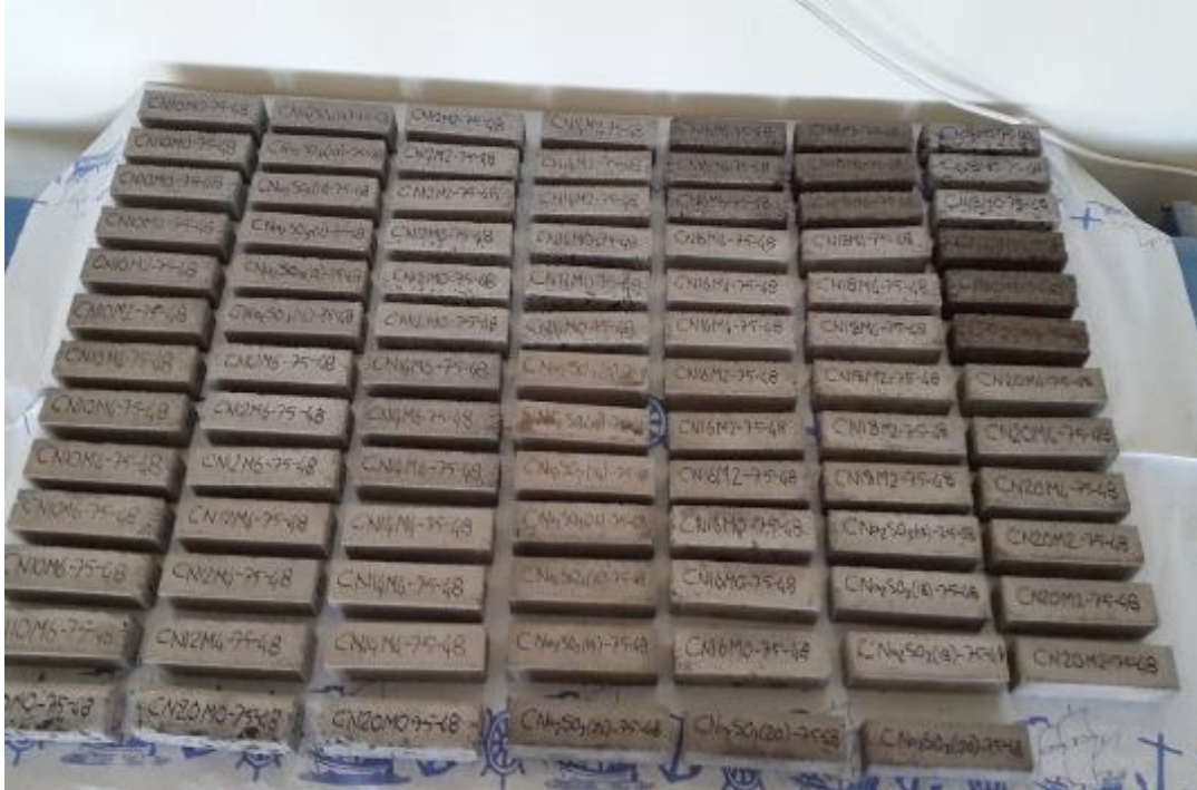
Şekil 4.24. Kagal C sınıfı uçucu kül ile üretilen, en uygun aktivatör deneme karışımları ve kodlamaları
