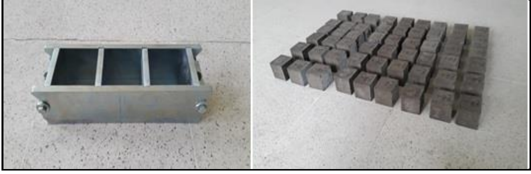
Şekil 4.41. 71×71×71 mm boyutlu küp kalıp ve numunelere
