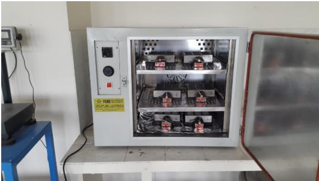
Şekil 4.19. Numunelerin etüve yerleştirilmesi
