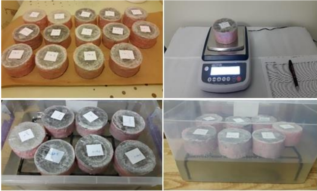
Şekil 4.44. Kapiller su emme deney numuneleri
