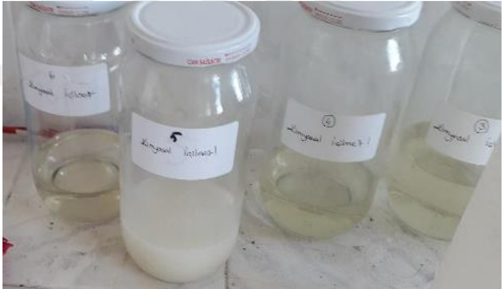
Şekil 5.4. Aktivatör karışımlarında 24 saatten fazla bekleme sonucu kristalleşme
