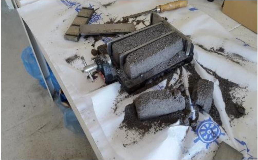
Şekil 5.1. Kangal C sınıfı uçucu külü ile üretilen su/bağlayıcı=0,45 olan numune
