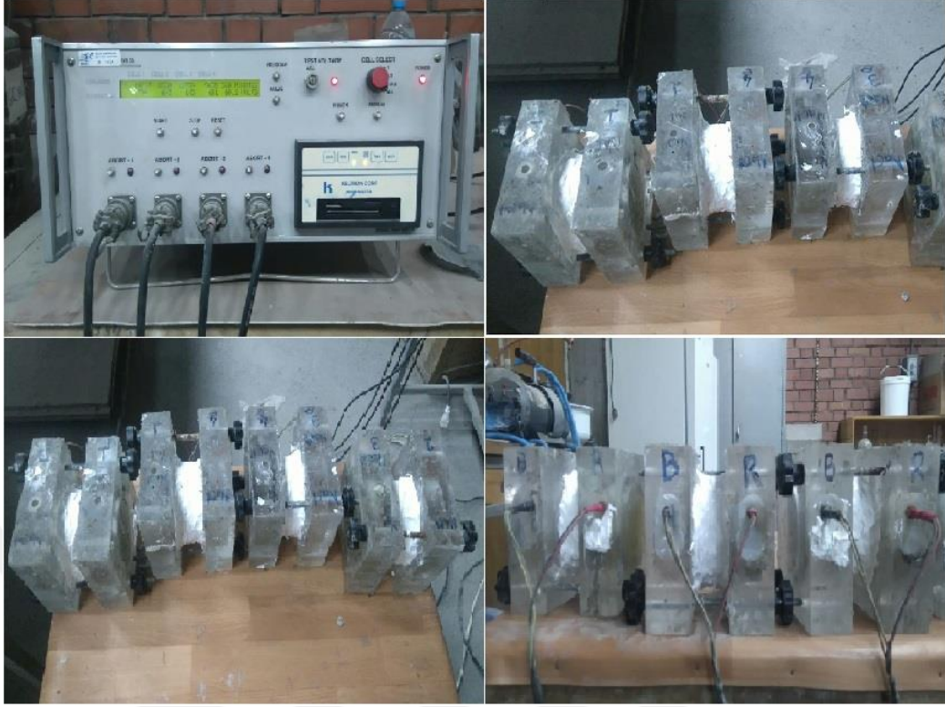
Şekil 4.46. Hızlı klorür geçirgenliği deneyi
