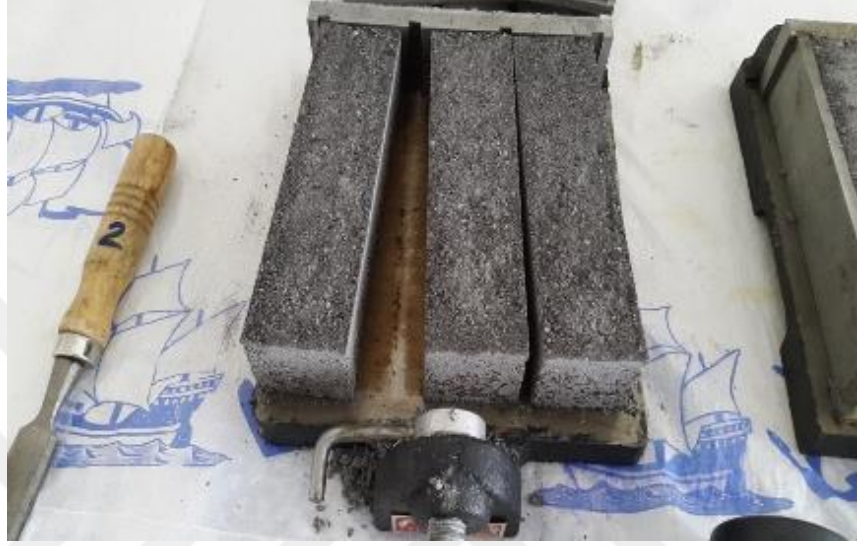
Şekil 5.2. Kargal c sınıfı uçucu külü ile üretilen numune (su/bağlayıcı=0,70 bağlayıcı/kum=1/3)
