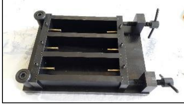
Şekil 4.37. Rötre için 40x40x160 mm boyutlu prizmatik harç numune kalıbı
