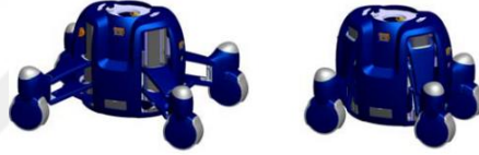
Şekil 1.9. Robotun alt platformu
