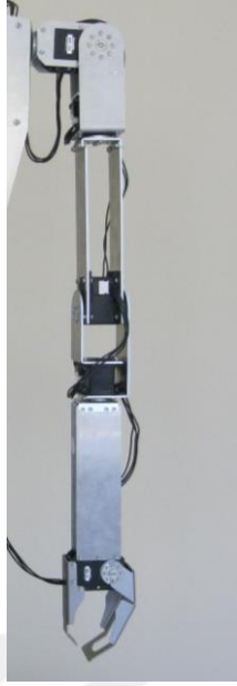
Şekil 5.6. İmalatı gerçekleştirilen robotun sol kolu
