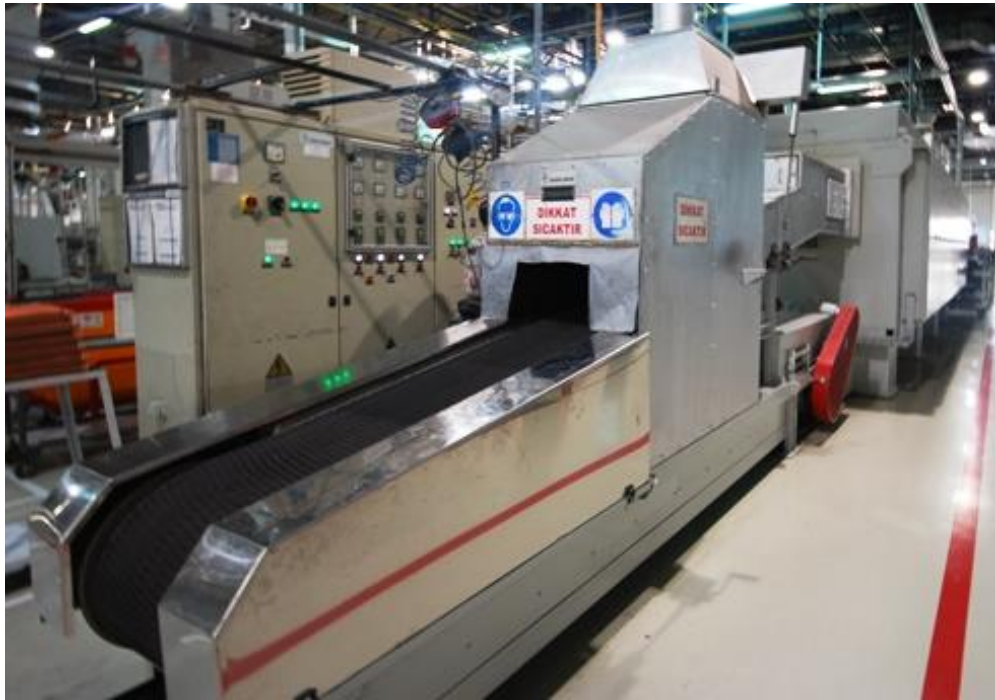
Şekil 2.32. Sinterleme fırını bant sistemi
