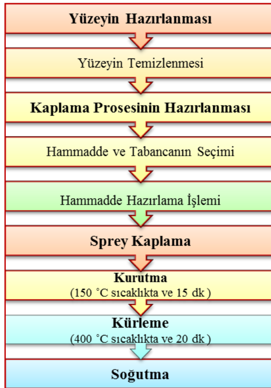
Şekil 3.9. Bronz numunelerin PTFE kaplama işlem akışı
