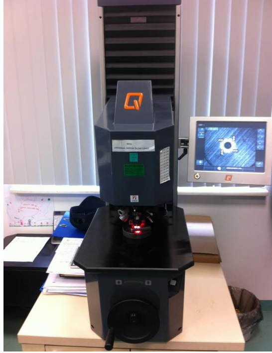
Şekil 3.20. Qness marka universal sertlik ölçüm cihazı
