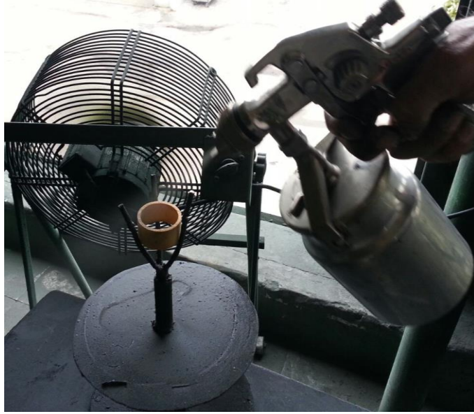
Şekil 3.12. Sprey kaplama işlemi
