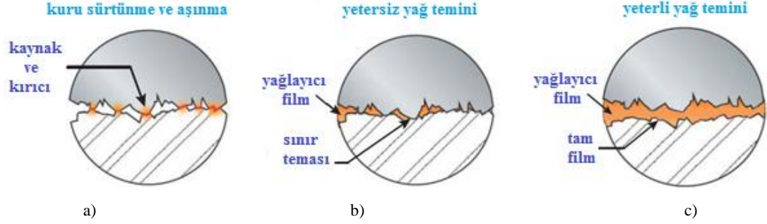
Şekil 2.10. Yağlayıcı maddenin bulunma durumuna göre sürtünme halleri, a) kuru sürtünme b) sınır sürtünme c) sıvı sürtünme [55].
