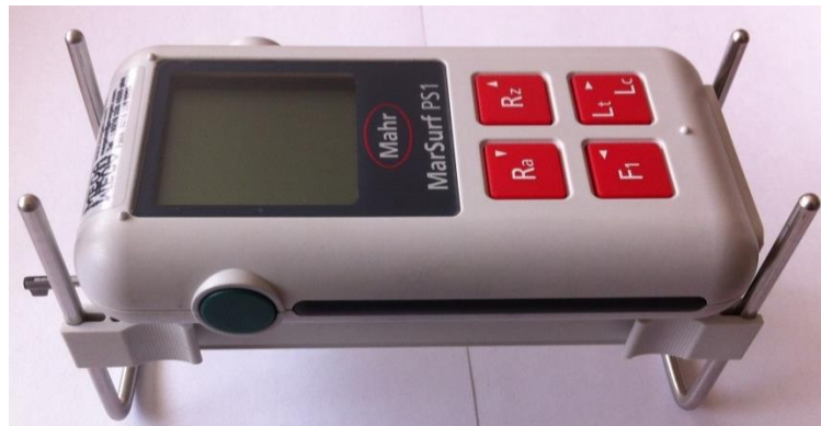
Şekil 3.16. Yüzey pürüzlülüğü ölçme cihazı
