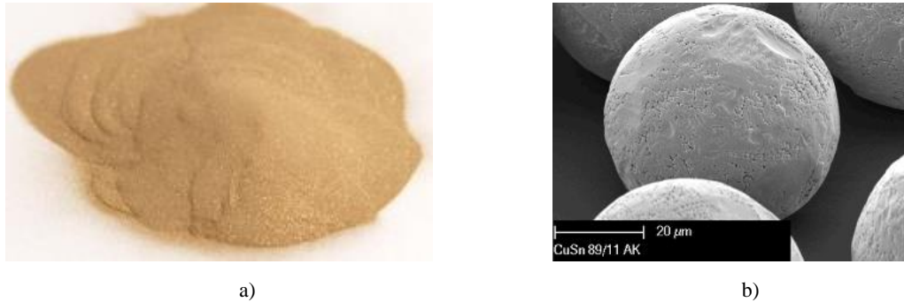
Şekil 3.2. Cu89Sn11 küresel bronz tozlarının, a) yığın görüntüsü, b) mikro görüntüsü [118].
