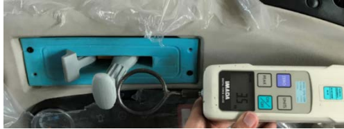
Şekil 10. Alternatif kol mekanizmasının kuvvet ölçümü
