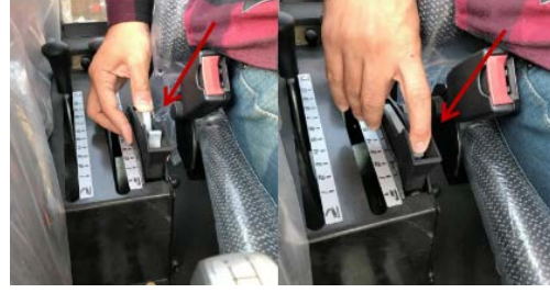
Şekil 11. Mevcut teknolift mandalın kullanım şekli
