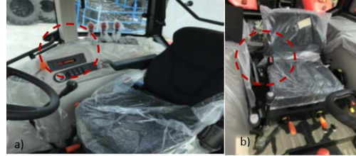
a) Sağ konsol üzerinde konumlu mevcut teknolift mandalı b) Koltuk yanında konumlandırılan teknolift mandalı
