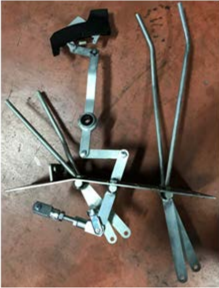
Şekil 4. Mevcut mekanik teknolift mandal mekanizmasının gerçek resmi
