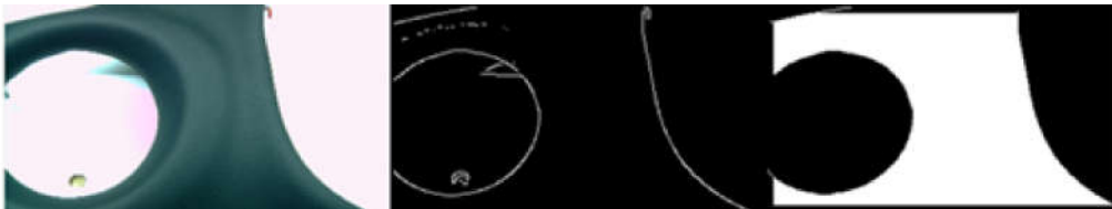
Şekil 11.6: Ürünün arka plandan ayrılması (Torkul, et.al., 2017)
