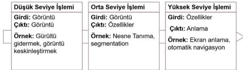
Şekil 5.2: Görüntü işlemeden bilgisayarlı görmeye işlem zorluk seviyesi [7]
