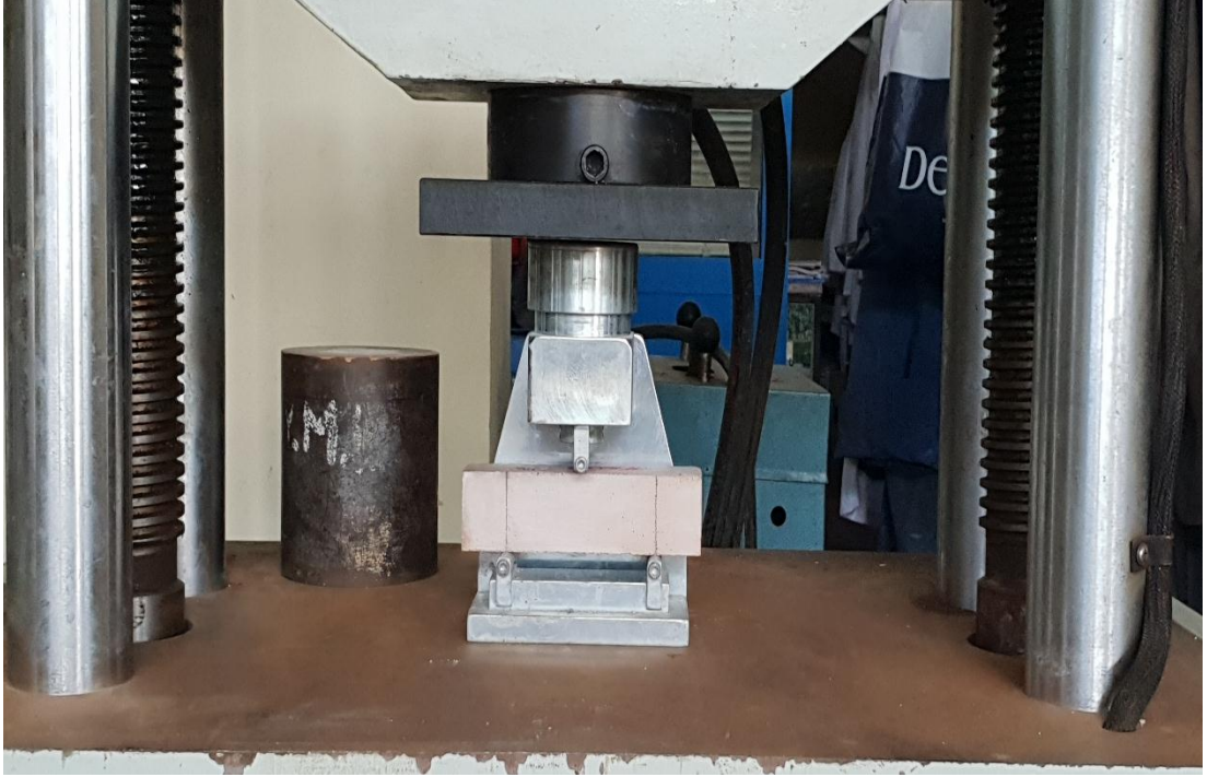
Şekil 3.18. Eğilme dayanımı testinin prizma numulere uygulanması
