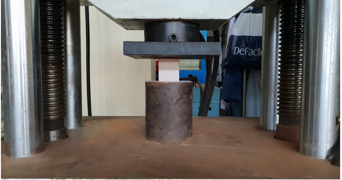
Şekil 3.17. Basınç dayanımı testinin küp numunelerde uygulanması
