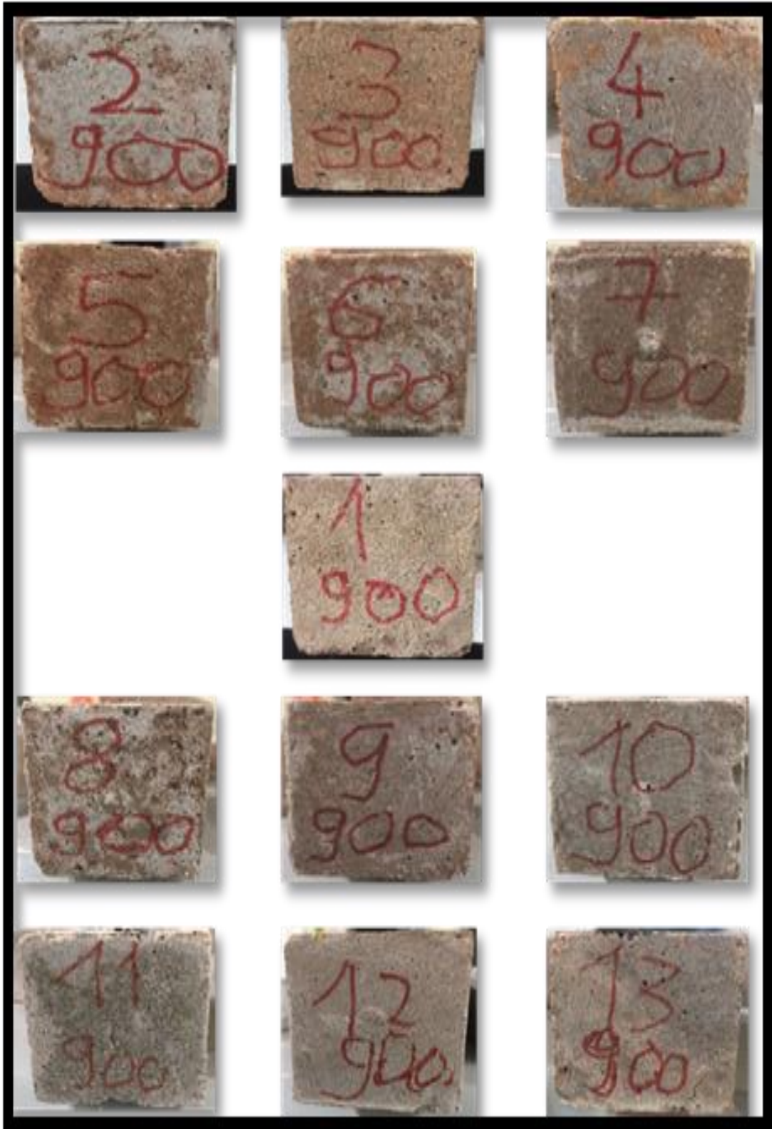
Şekil 4.16. Yüksek sıcaklığa maruz kalan geopolimer numunelerin görsel incelenmesi (900°C)
