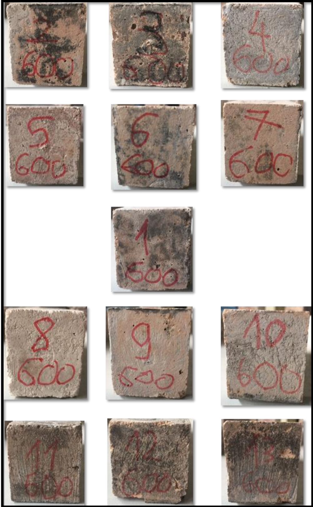
Şekil 4.15. Yüksek sıcaklığa maruz kalan geopolimer numunelerin görsel incelenmesi (600°C)
