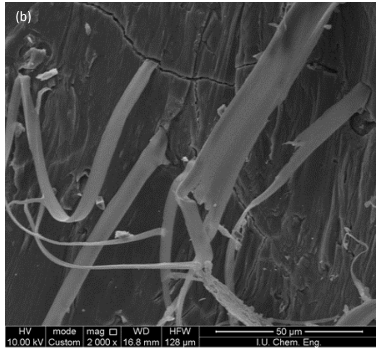
Şekil 4.20. 300°C yüksek sıcaklığa maruz kalmış PVA lifli numunelerin SEM görüntüleri (a) ve (b)
