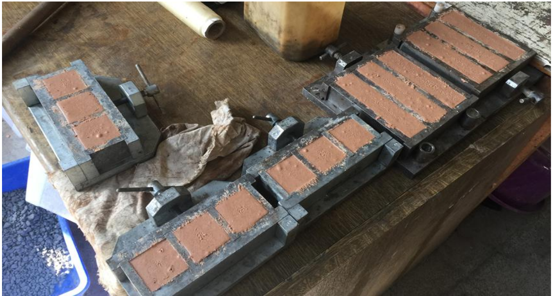
Şekil 3.30. 50 x 50 x 50 mm küp ve 40 x 40 x 160 mm prizma kalıplar
