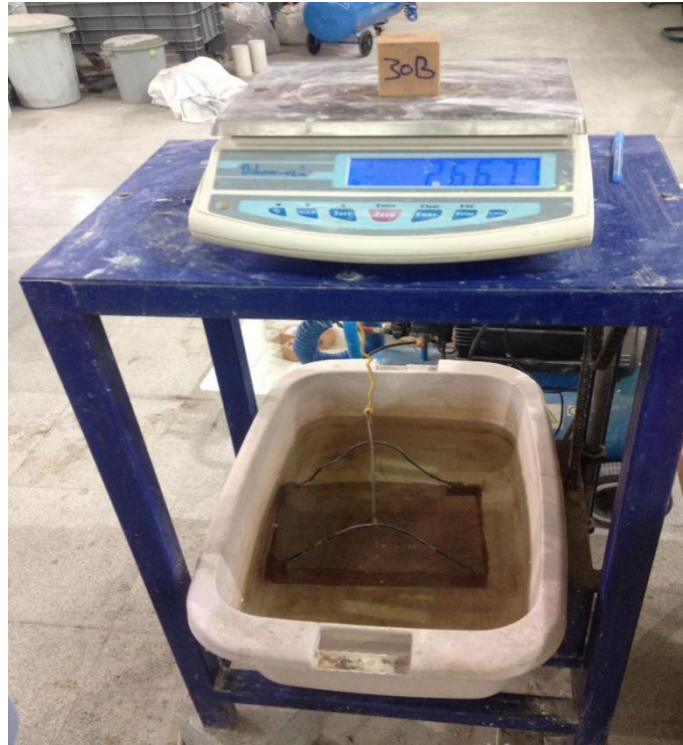
Şekil 3.21. Arşimed deney düzeneği
