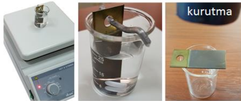
Şekil 6.24. Magnetik karıştırma eşliğinde, ilaç çözeltisinde bekletme-kurutma ile ilaç yükleme
