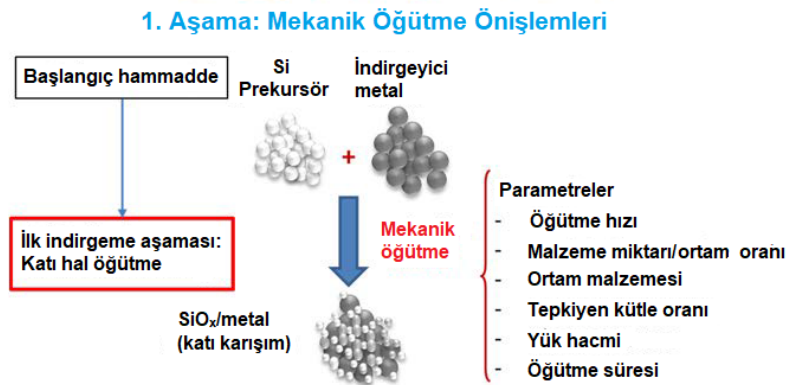
Şekil 4.28. Gözenekli Si elde edilmesinde ilk aşama indirgeme/yükseltgenmenin şematik diyagramı [8]
