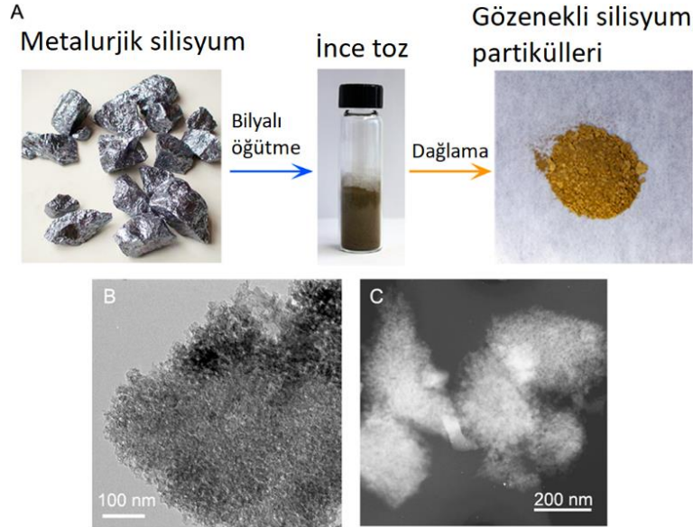
Şekil 4.36. Gözenekli silisyum partiküllerinin sentezi ve morfolojisi şeması (A) Metalurjik silisyumdan bilyalı öğütme ve dağlama işlemine kadar gözenekli silisyumun sezntezlenmesi (B) Gözenekli Si partiküllerinin bir TEM görüntüsü (C) Nano gözenekli Si partiküllerinin STEM görüntüsü [209]
