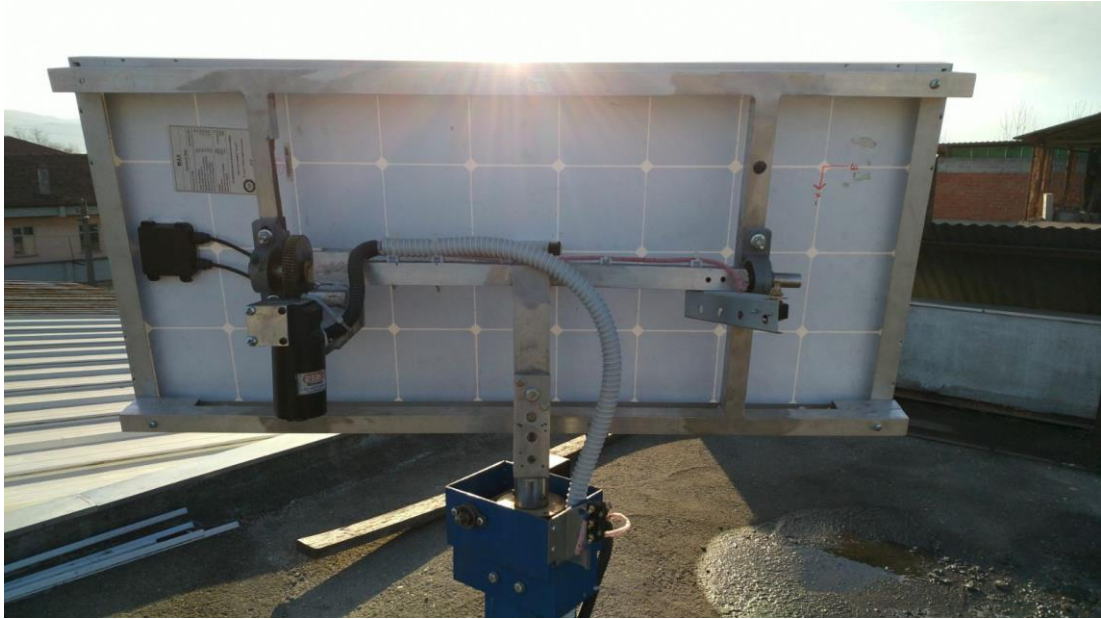
Şekil 5.6. Güneş izleyen sistem mekanik aksam son hali
