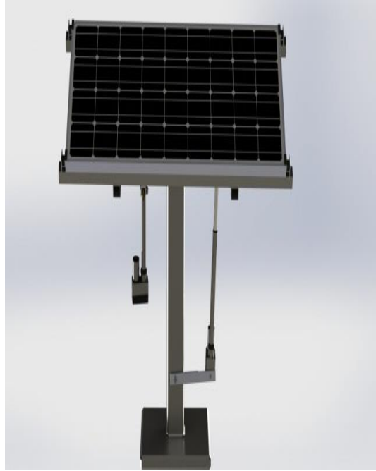
Şekil 5.4. Güneş izleyen sistem için Solidworks ortamında mekanik aksam tasarımı
