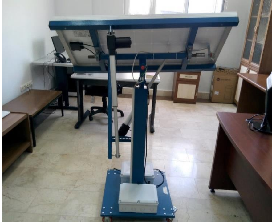
Şekil 5.5. Güneş izleyen sistem mekanik aksam kurulumu
