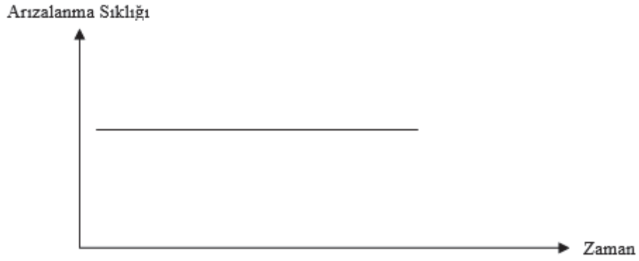
Şekil 3.5. Elektrik-elektronik sistemlerin arıza karakteri
