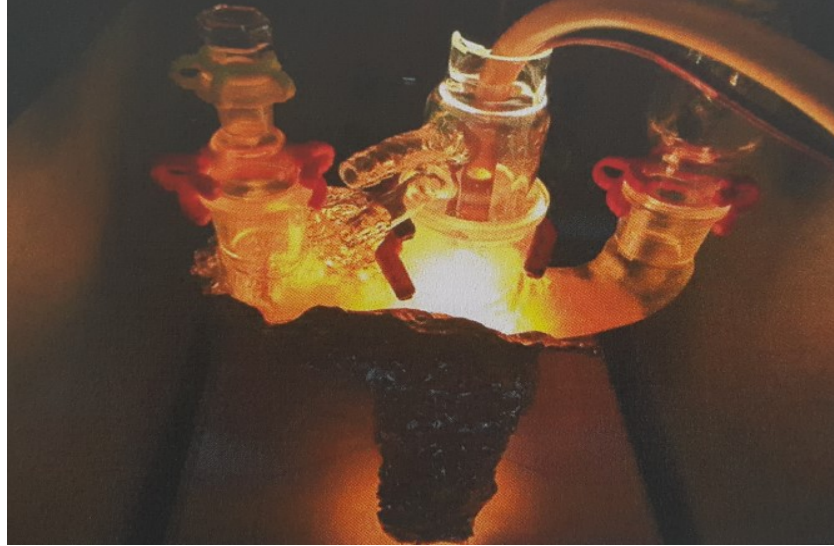
Şekil 3.2. Yüksek sıcaklık brominasyonunda kullanılan bir sistem
