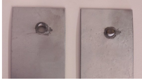
Şekil 2.7. Direnç nokta kaynağında makaslama hasarı
