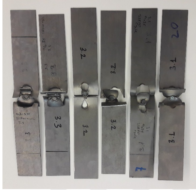
Şekil 5.37. Yorulma testi sonucunda kopan TWIP 1000 (1,4 mm)-TWIP 1000 (1,4 mm) kaynaklı bağlantılar
