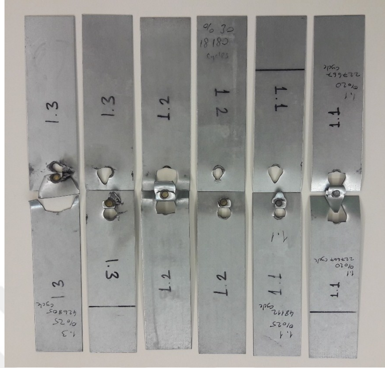
Şekil 5.31. Yorulma testi sonucunda kopan DP 800 (0,8 mm)-DP 800 (0,8 mm) kaynaklı bağlantılar
