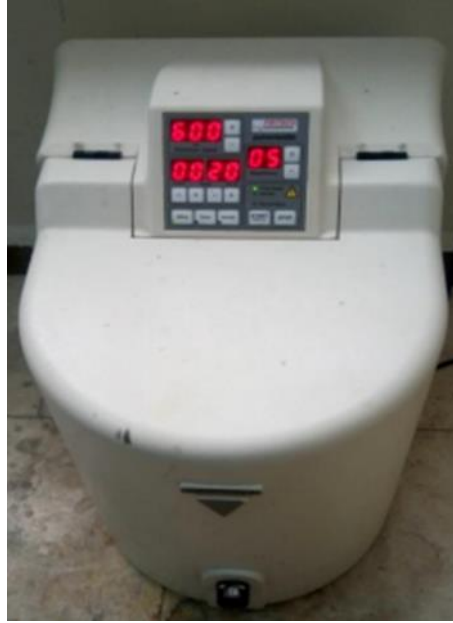
Şekil 4.5. Deneysel çalışmalarda kullanılan gezegensel değirmen
