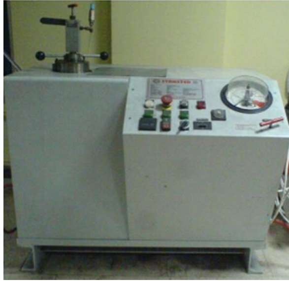
Şekil 4.6. Deneysel çalışmalarda kullanılan soğuk izostatik pres
