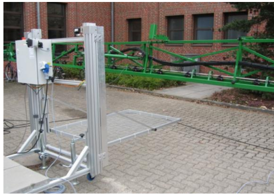
Şekil 2.6. Hareketli test platformu (Herbst ve ark., 2015).
