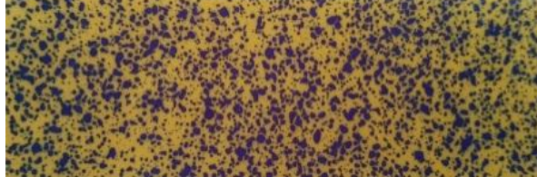
Şekil 3.8. Arazi deneylerinde kullanılan suya duyarlı kağıt püskürtme sonrası görünümü
