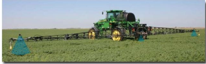
Şekil 2.17. Ticari olarak geliřtirilmiř bum yükseklik kontrol sistemi řematik gösterimi ve resmi (Norac, 2015).
