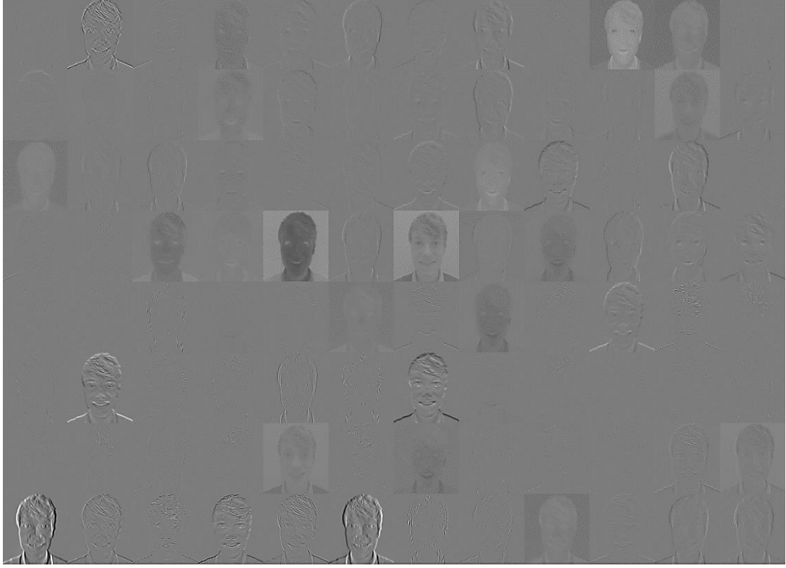
Şekil 3.23. Örnek girdiye konvolüsyon çekirdeklerinin uygulanması sonucu oluşan katman çıktıları [121].
