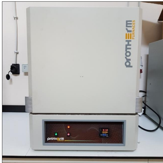
Şekil 4.6. Protherm PLF 130/15 model kamara tipi fırın.
