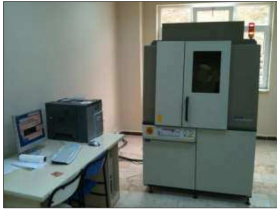
Şekil 4.8. RIGAKU® XRD D/MAX/2200/PC marka x-ışınları difraktometresi.
