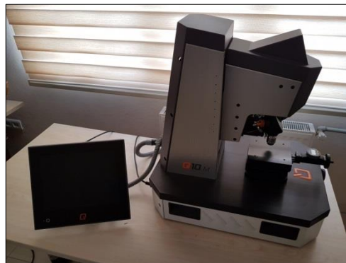
Şekil 4.9. QNESS Q10M model Vickers mikrosertlik ölçüm cihazı.
