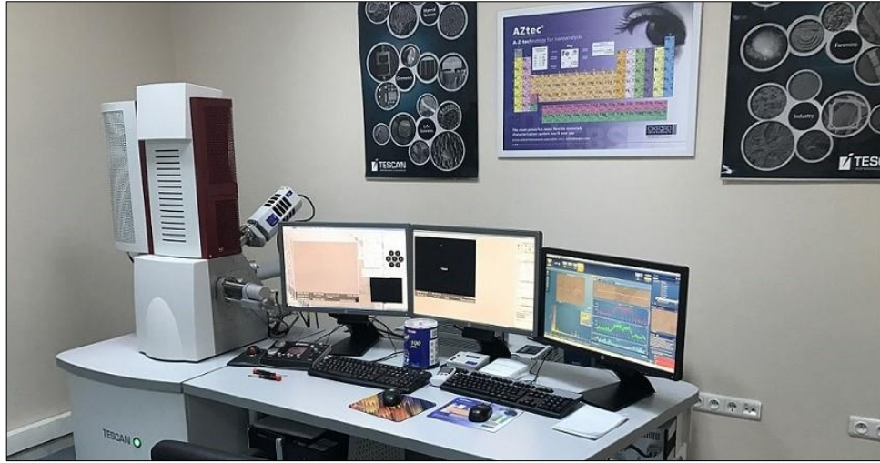
Şekil 4.7. TESCAN MAIA3 XMU model taramalı elektron mikroskobu.
