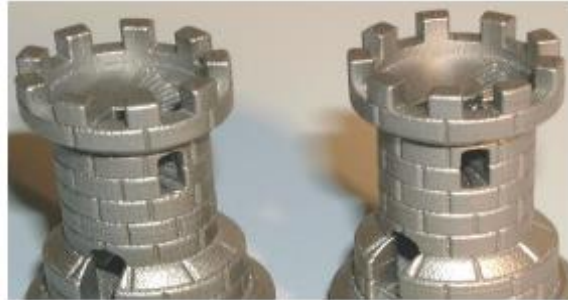
Şekil 26: Karmaşık Yapıdaki Parçaların Doğrudan Hızlı Prototipleme ile Üretimi
