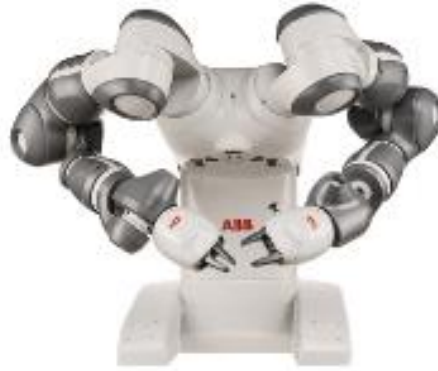
Şekil 5: ABB Tarafından Tasarlanmış İki Kollu Yumi Robotu
