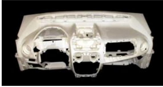
Şekil 34: ABS Malzemedен Üretilmiş Parçaların Kaynak Metodu Kullanılarak Bir Araya Getirilmesi
