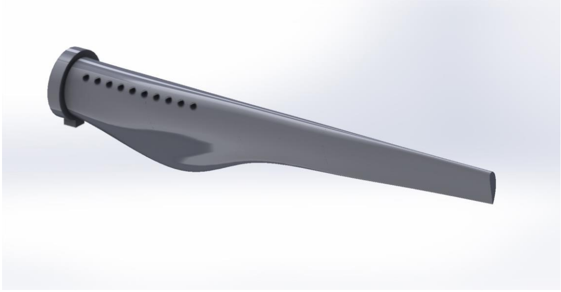
Şekil 3.3. 10 hava kanalı bulunan rotor kanadı
