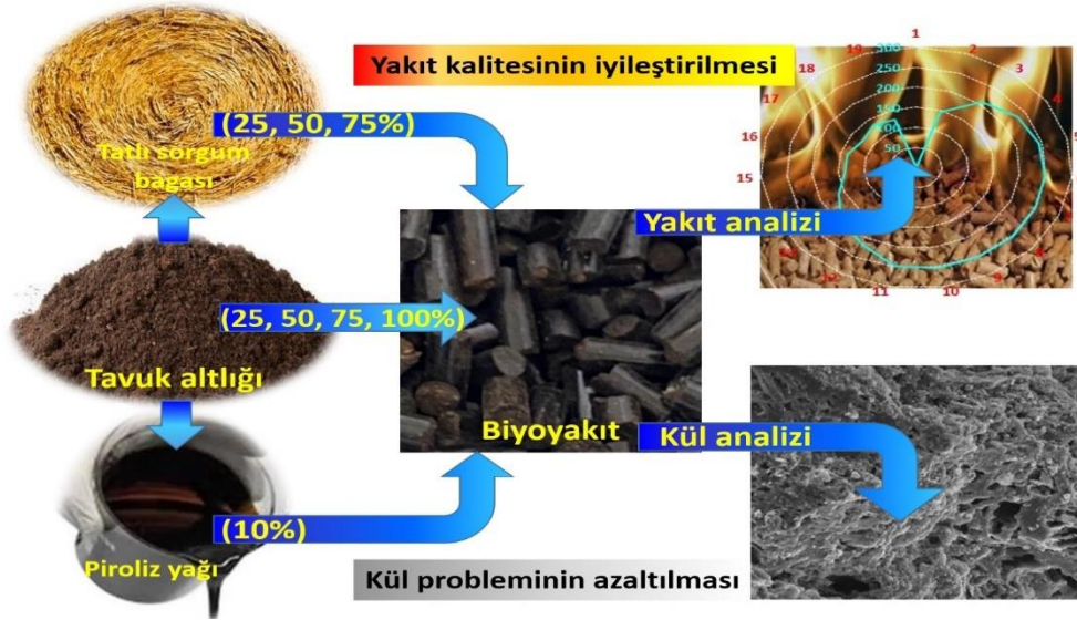
Şekil 3.9. Tavuk altlığının yanma özelliklerini ve kül depozit problemlerini iyileştirmek için birlikte yakma uygulamasının ve gerçekleştirilen analizlerin şematik gösterimi
