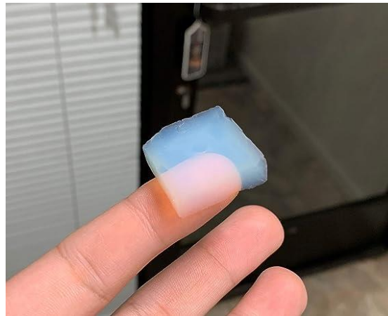
Şekil 2.3. Örnek bir silika arojelin makro görüntüsü [38].
