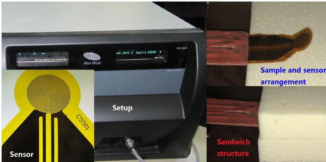
Şekil 3.16. TPS yönteminin genel şeması, örnek ve sensör düzenlemesi [152].
