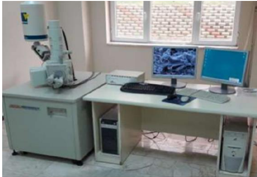
Şekil 4.10. Joel Jsm-5600 marka taramalı elektron mikroskobu. [73]
