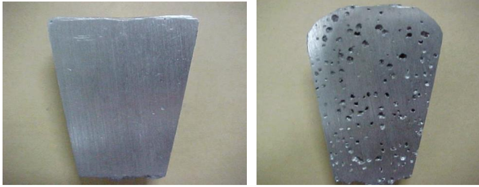
Şekil 2.16. a) Gaz porozitesi bulunmayan ve yoğunluğu 2.70 \text{ g/cm}^3 b) Gaz porozitesi bulunan ve yoğunluğu 2.58 \text{ g/cm}^3 olan Al döküm parçaları [33].
