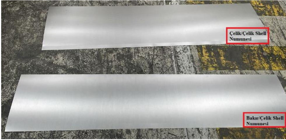
Şekil 3.1. 5-7 mm aralığında farklı shell malzemeleri ile üretilen döküm numuneleri.
