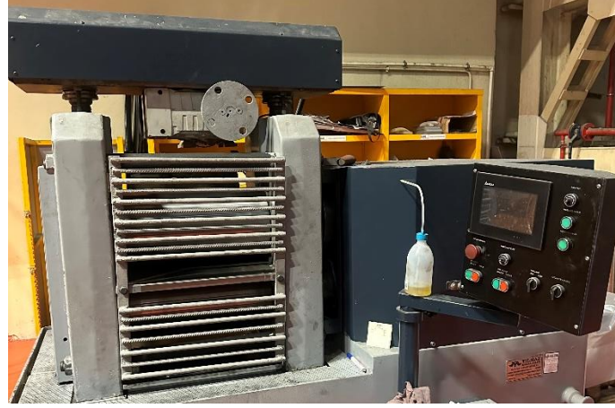
Şekil 3.2. Delta marka laboratuvar ölçekli hadde makinesi.
