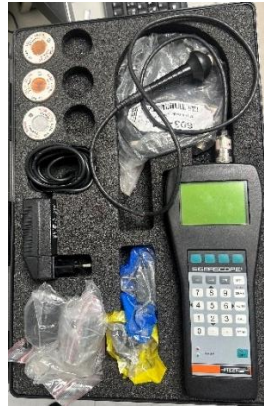
Şekil 3.10. Fischer marka iletkenlik ölçüm cihazı.
