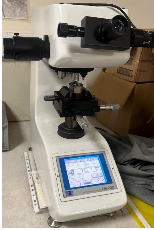
Şekil 3.9. Future-tech Vickers mikrosertlik ölçüm cihazı.
