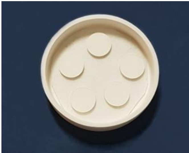
Şekil 3.3. 200 MPa basınç uygulanarak preslenmiş numuneler.
