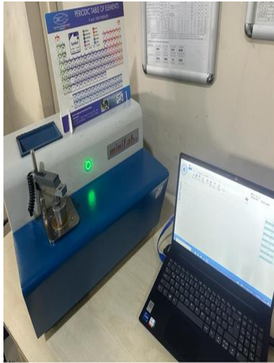
Şekil 4.8. GNR marka S1 MiniLAB 150 model spektrometre cihazı.
