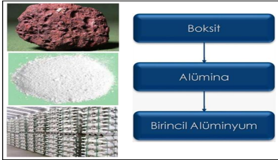
Şekil 2.4. Alüminyum üretimi aşamaları [17].
