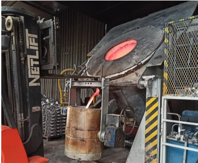
Şekil 4.14. Devirmeli ertitme fırını ile gerçekleştirilen ertitme prosesi.
