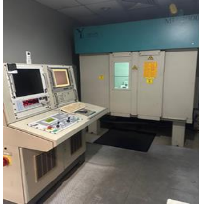
Şekil 4.11. YXLON MU 2000 (160 kW) marka radyoskopi cihazı.
