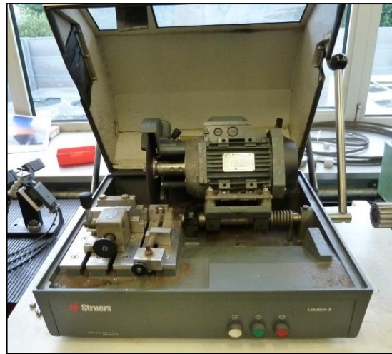
Şekil 4.3. STRUES LABOTOM-3 marka makro kesme cihazı.
