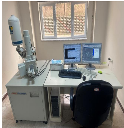
Şekil 4.7. JEOL JSM 6060LV marka masaüstü taramalı elektron mikroskobu.
