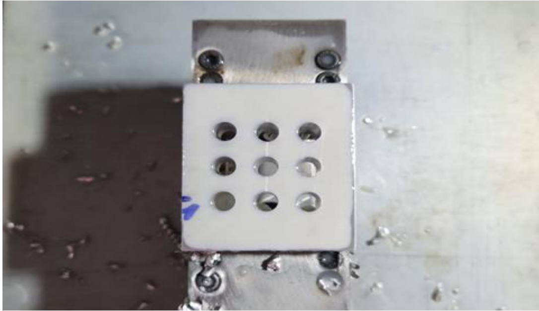
Şekil 4.6. Sıvı soğutma yöntemi ile delinen numune.
