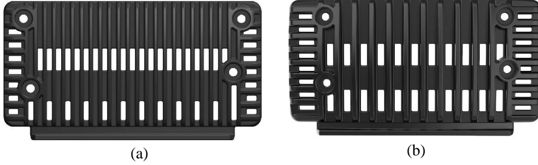
Şekil 5.19. Optimal yan kapakların tasarımı (a) Analizleri yapılan yan kapak (b) Geliştirilmiş yan kapak
