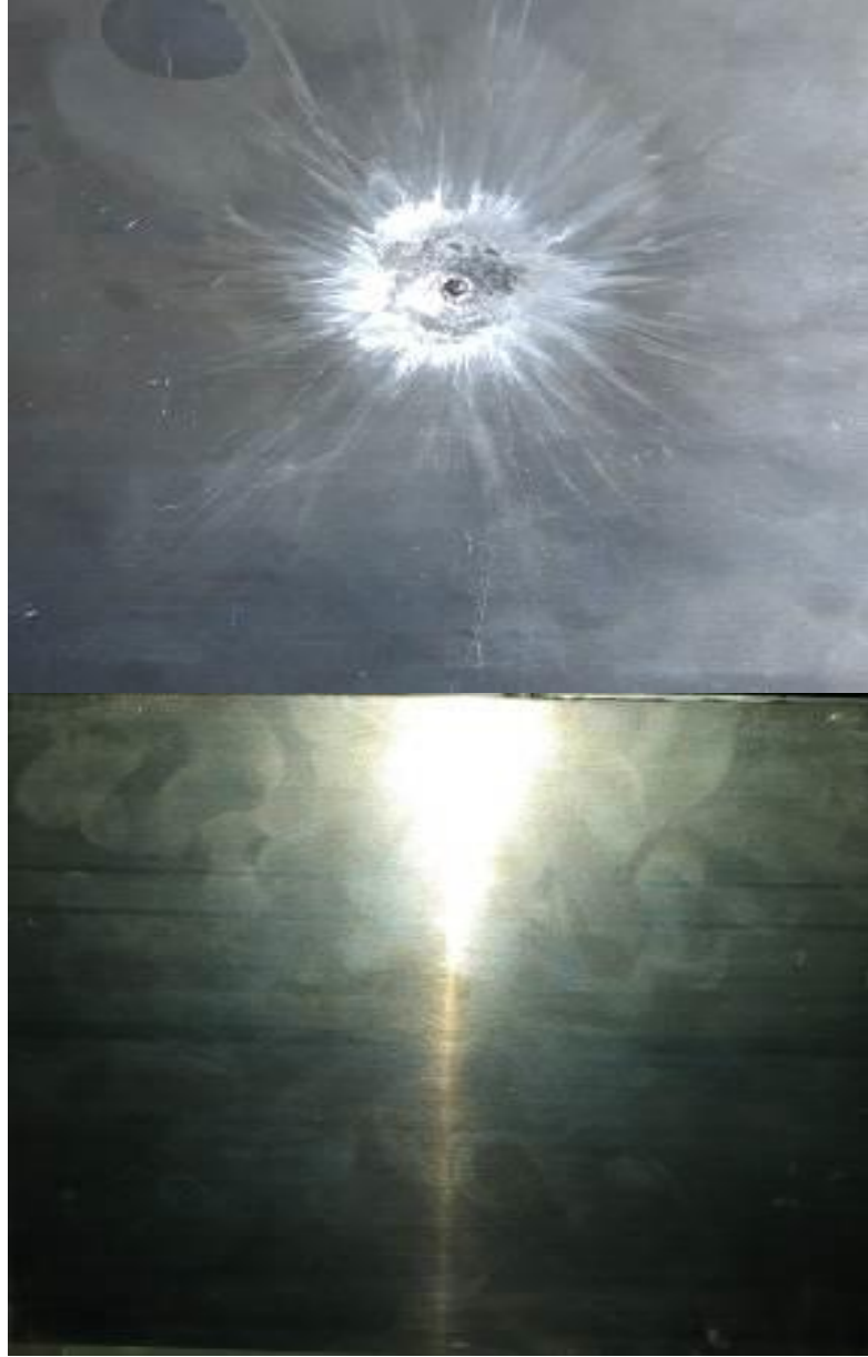
Şekil 4.7. 15 mm numunenin ön ve arka yüzü.
