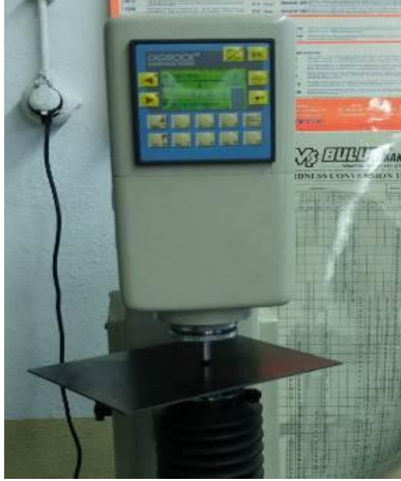
Şekil 4.2. Sac malzemenin sertlik ölçümü.
