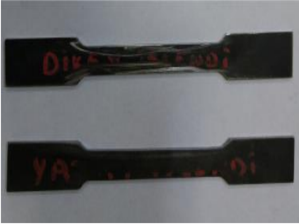
Şekil 4.4. Ck 75 sacdan hazırlanan çekme numuneleri.
