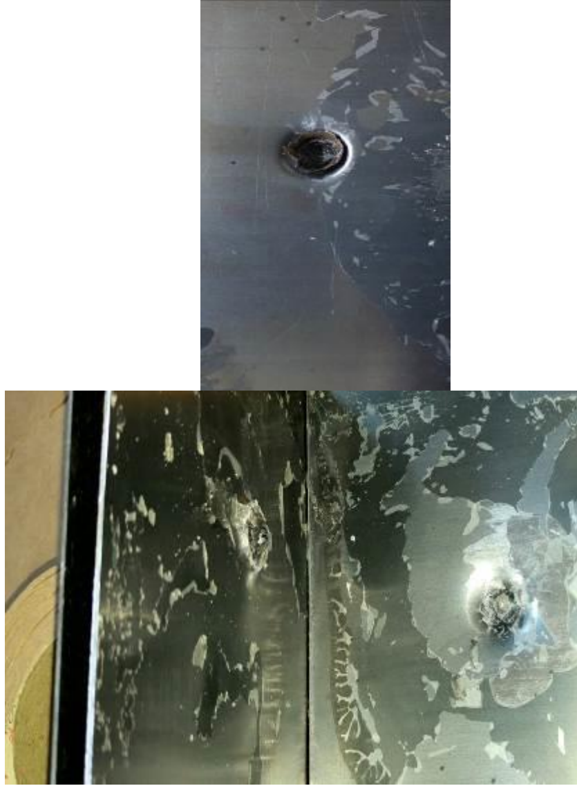
Şekil 4.9. 13 mm numune ön yüz ve delinmiş 2mm sac
