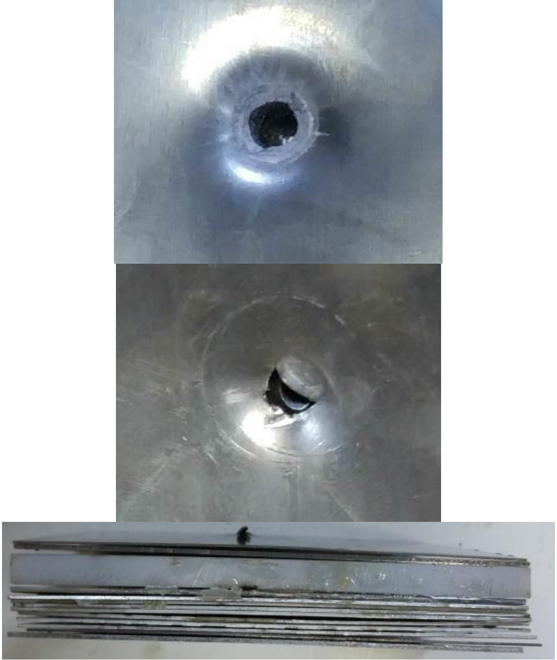
Şekil 4.18. 2-1. kodlu numunenin ön, arka ve üst yüzü.
