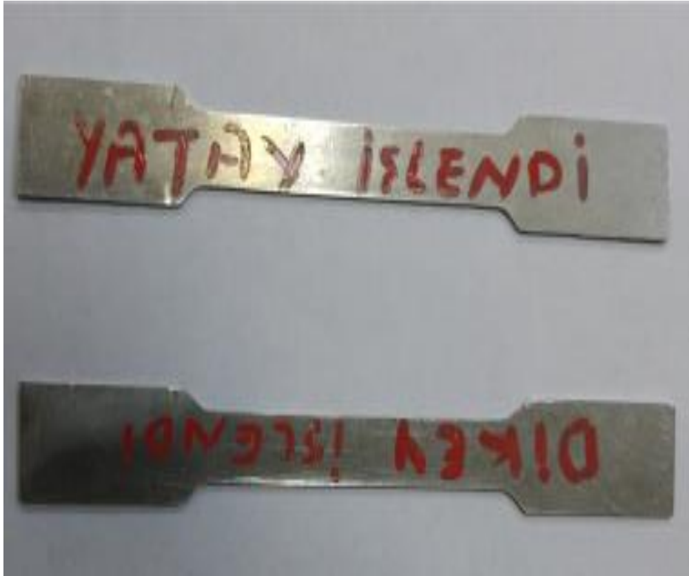
Şekil 4.5. Al 7075 T6 sacdan hazırlanan çekme numuneleri.
