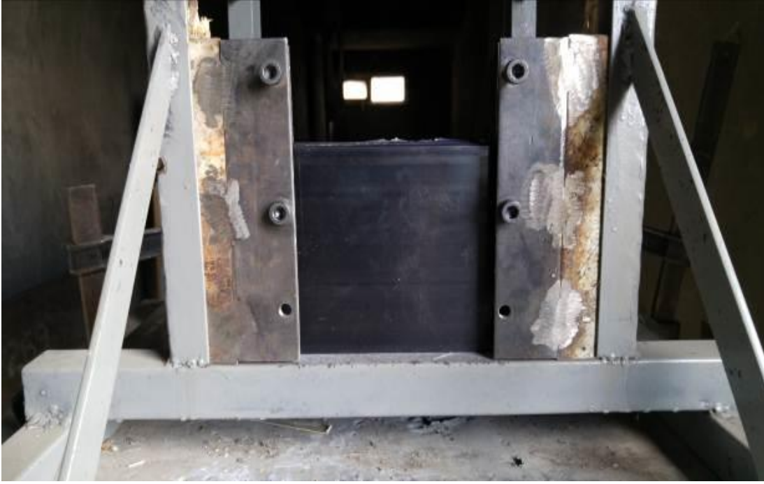
Şekil 4.6. Katmanlı numune örneği (15 mm Ck 75).
