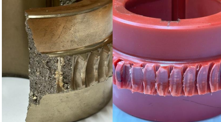
Şekil 5.15. Globoid dişli formlarının kırılma yapıları
