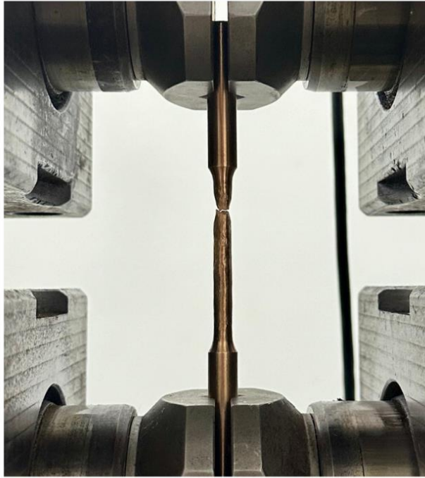
Şekil 5.6. Fosfor bronzunun çekme görüntüleri
