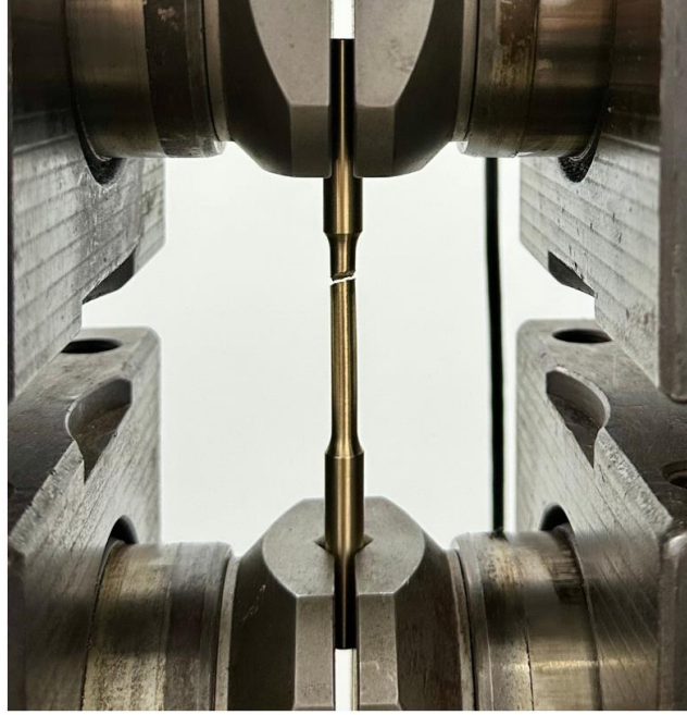
Şekil 5.5. Alüminyum bronzunun çekme görüntüleri
