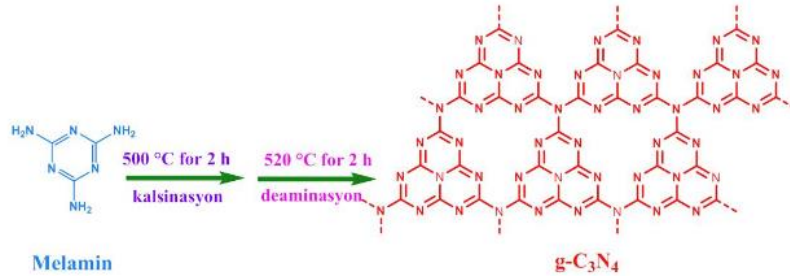
Şekil 3.2. Melamin kullanılarak g-C 3 N 4 eldesi
