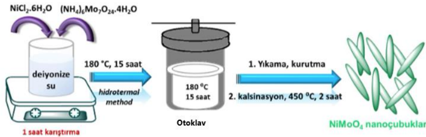
Şekil 3.1. NiMoO 4 nanoçubukların hazırlanması
