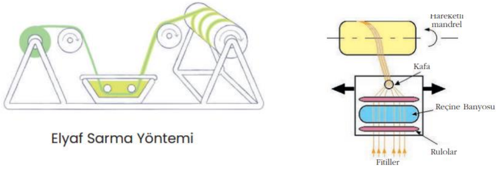
Şekil 2.17. Kompozit Malzeme Üretimi Elyaf Sarma (CTP Teknolojisi, 2018)
