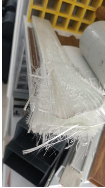
Şekil 2.6. Kompozit Profil Üretimi Cam Lifi Görsele
