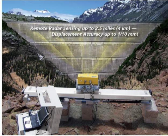
Şekil 3.11. Yersel InSAR ile baraj gövdesinin taranması (Uzel ve ark., 2012).
