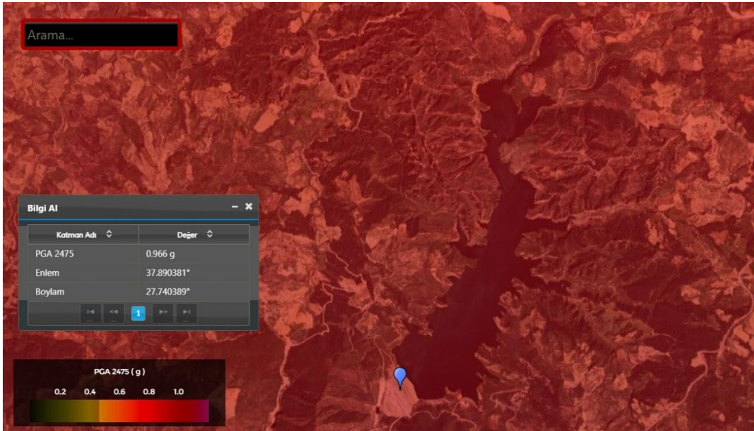
Şekil 4.14. AFAD Türkiye Deprem Tehlike Haritasından 2475 yıllık geri dönüş periyodu için elde edilen PGA değeri.
