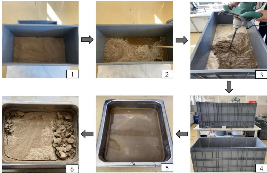
Şekil 3.4. Çöktürme tekniği uygulama aşamaları.
