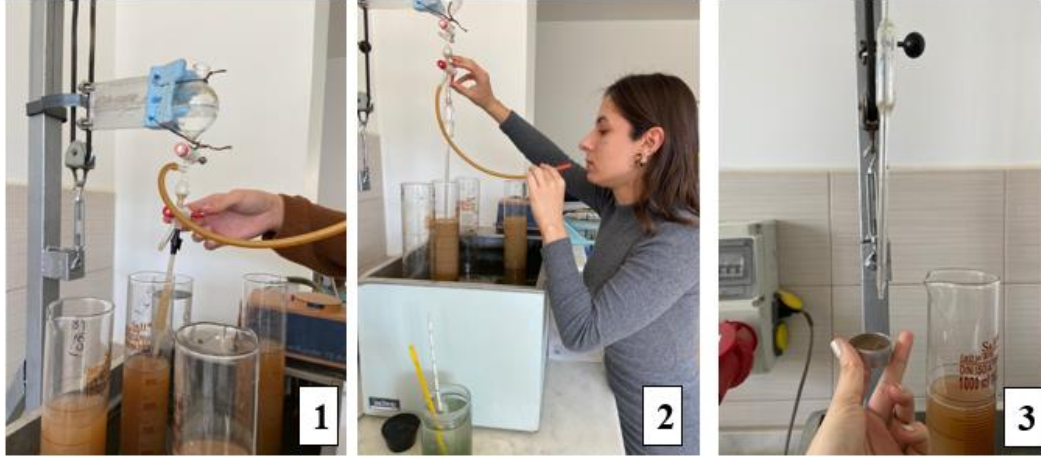
Şekil 3.22. Pipet deney aşamaları.
