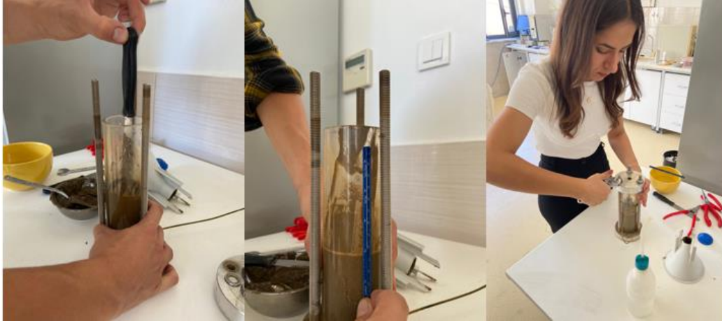
Şekil 4.2. Bulamaç numunesinin plexiglass tüpüne yerleştirilmesi.
