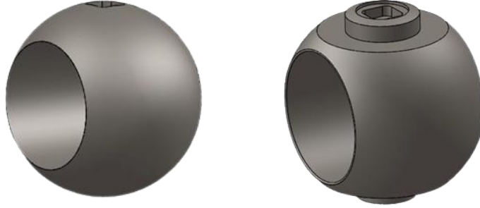
Şekil 4.15. Optimizasyon Öncesi (Sol) ve Sonrası (Sağ) Kürenin Ağırlıkla Modellenmesi.
