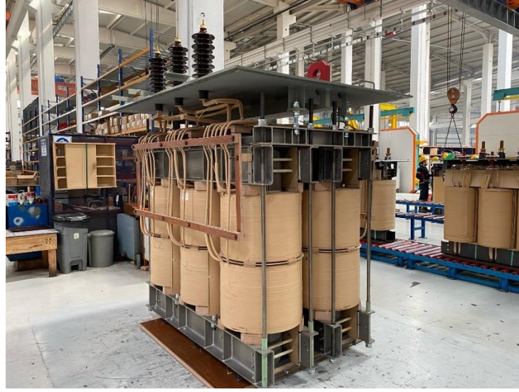
Şekil 4.2. MCR aktif kısım üretim sonu
