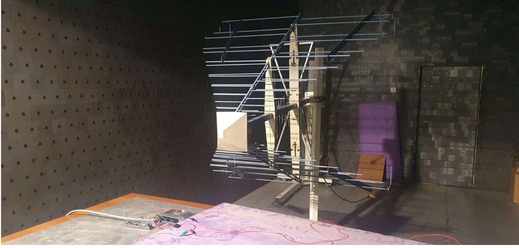
Şekil 5.3. EMC test düzeneği
