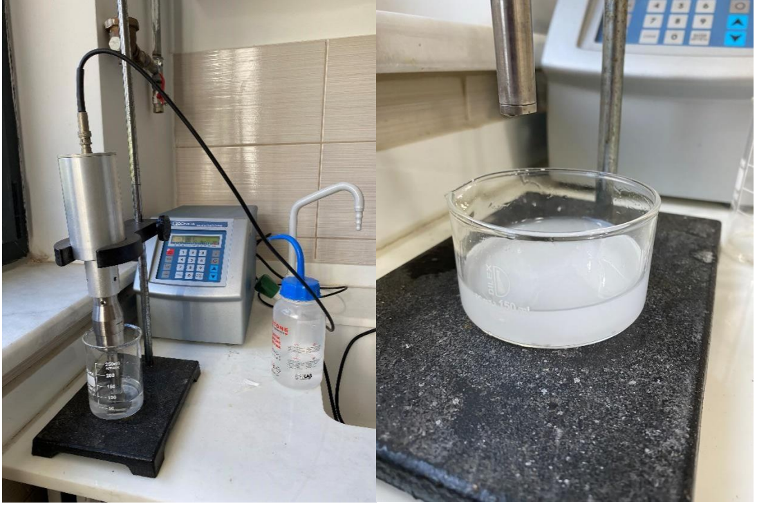
Şekil 3.10. Kullanılan sonikatör cihazı ve hazırlanan karışım.
