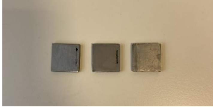
Şekil 3.15. Altlıkların aşınma denemeleri sonrası görüntüsü.
