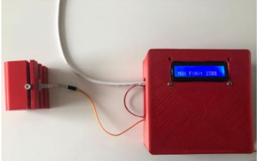
Şekil 4.1. Arduino kullanılarak kuvvet değişiminin ölçülmesinde kullanılan kalibrasyon mekanizması (kalibrasyon test düzeneği).
