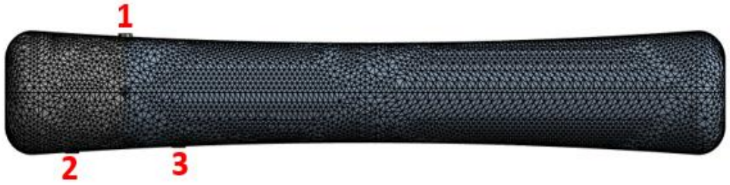
Şekil 4.3. Tasarlanan metakarpal kırık modeli analizinde uygulanan mesh(ağ) yapısı.
