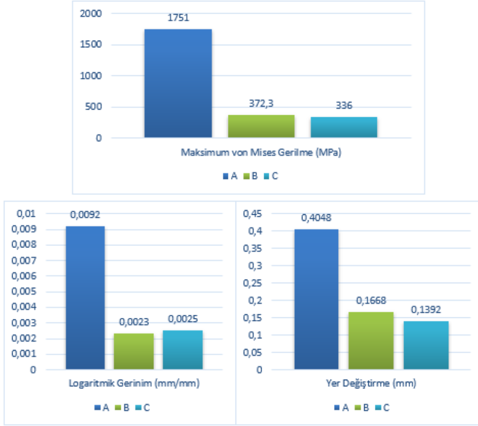
Şekil 3.9. A, B ve C modellerinin analiz sonuç bilgileri (a); von mises gerilme değerleri, (b); gerinim değerleri, (c); yer değiştirme değerleri.
