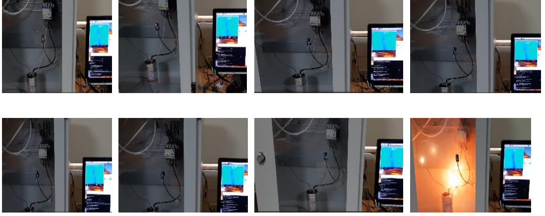
Şekil 3.26. 2,5kvar, 7 tel eksiltmiş beyaz kablo deneyinde meydana gelen yanma koşullarını gösteren görüntüler.
