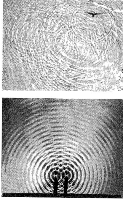
Şekil 2: Suda Oluşan Kırınım (üstteki) ve Girişim (alttaki) Desenleri
