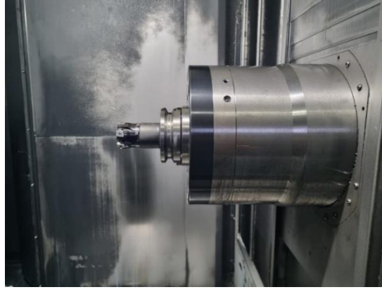
Şekil 5.7. Finiş freze takımının tezgahdaki görüntüsü.
