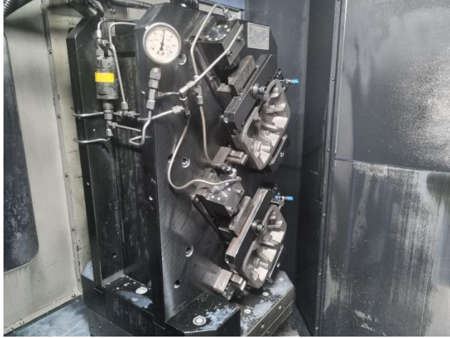
Şekil 5.2. İş parçasının fikstür üzerindeki yerleşimi.
