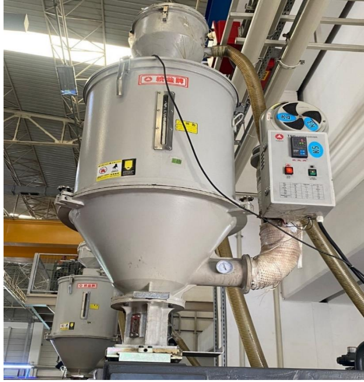
Şekil 3.3. Plastik enjeksiyon hunisi (silo)
