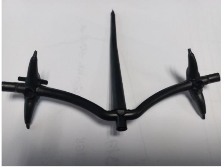
Şekil 3.8. Örnek yolluk şekli (muz tipi yolluk-soğuk yolluk)
