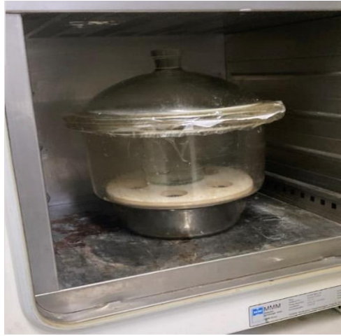
Şekil 3.3. Cam desikatör ile etüv içerisinde doku iskelelerinin çapraz bağlanma işleminin yapılması.
