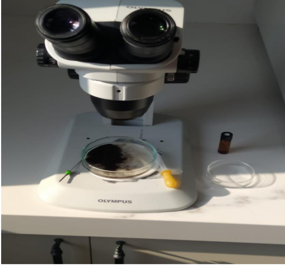
Şekil 3.10. Stereomikroskop altında pipet ve iğneyle ayıklama işlemi
