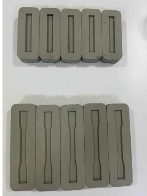
Şekil 3.5. Standartlara göre hazırlanmış silikon kalıplar.
