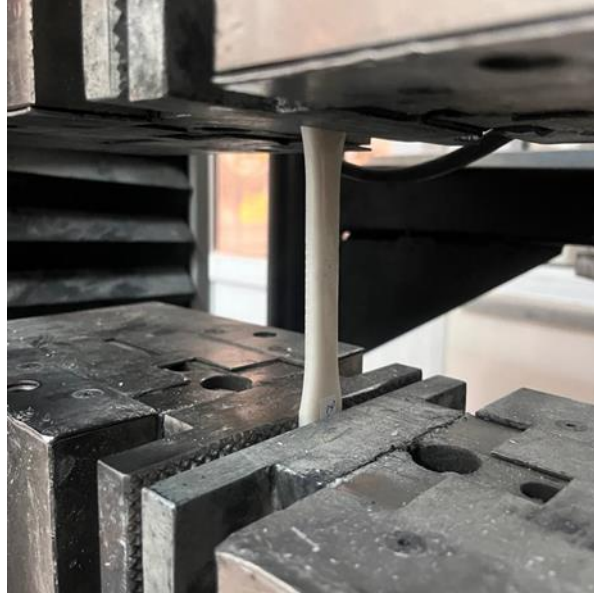
Şekil 4.8. Çekme testi yapılan %2 ZrO 2 katkılı numune.
