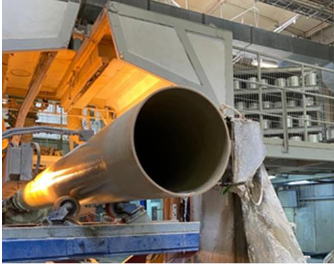
Şekil 3.16. \text{SiO}_2 katkılı boru üretimi.
