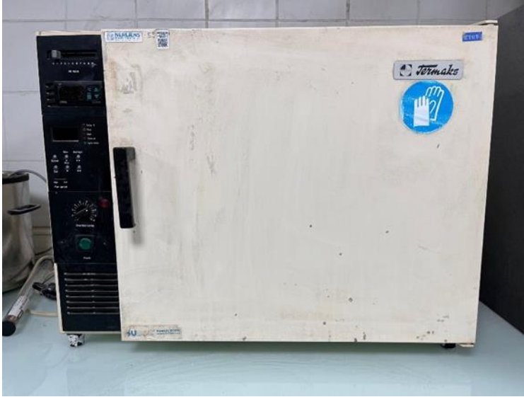
Şekil 3.9. Post kürlenme işleminde kullanılan Termaks marka etüv.
