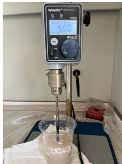
Şekil 3.3. Mekanik karıştırıcı karıştırma işlemi (WiseStir HT50DX).
