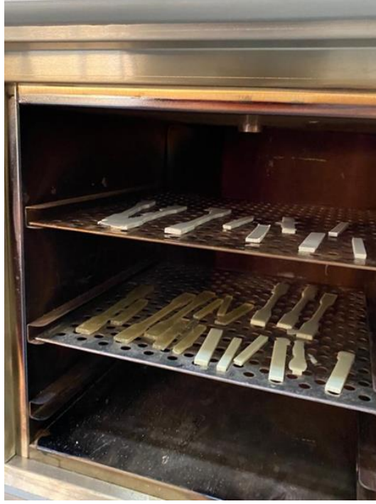
Şekil 3.8. Etüvde post kür işlemi.
