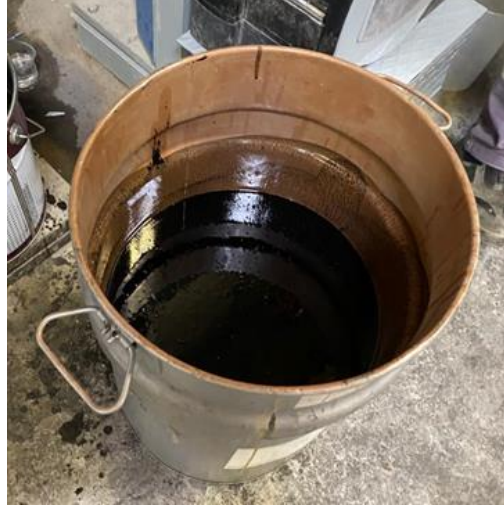
Şekil 3.15. Boru üretimi için hazırlanmış karbon nanotüp katkılı reçine.
