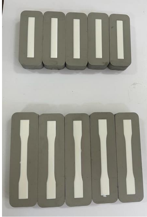
Şekil 3.7. Kalıplara dökülmüş numuneler.
