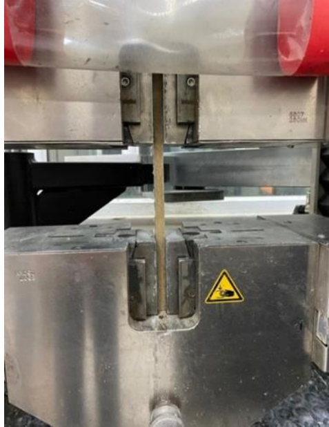
Şekil 4.31. Nano SiO 2 katkılı boru aksenal çekme dayanım testi.
