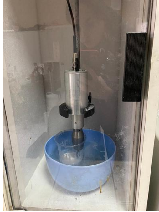
Şekil 3.4. Ultrasonik karıştırıcıda karıştırma işlemi (Sonic VC750).
