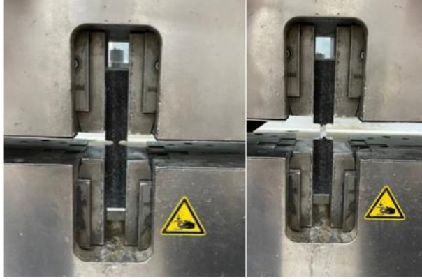
Şekil 4.27. Karbon nanotüp katkıli boru çember çekme dayanım testi.
