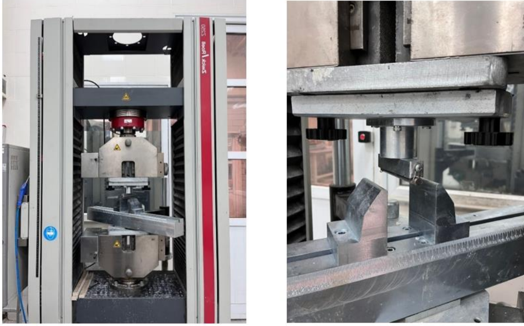
Şekil 3.13. Zwick-Roel Z250 test cihazı üç nokta eğme testi aparatları.
