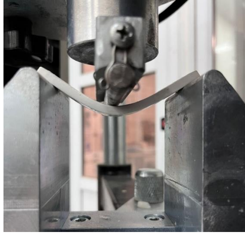
Şekil 4.26. TiO 2 numunesi üç nokta eğilme testi.
