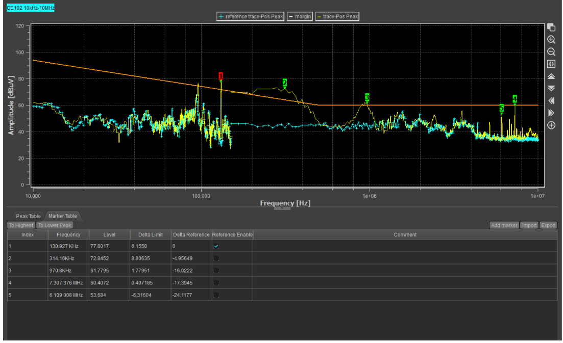
Şekil 3.47. Kablo topraklaması sökülüp TDK'nın DA filtresi dışarı alınmış durumdaki ölçüm sonucu.
