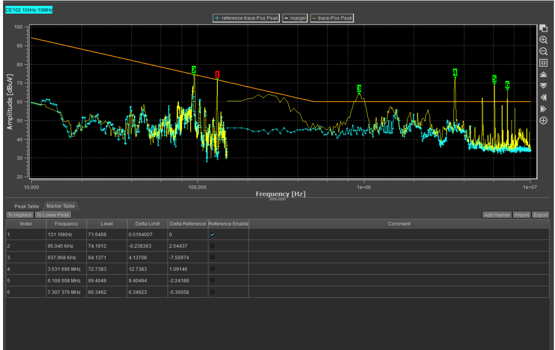
Şekil 3.48. TDK RDEN 4850 DA filtre yerine 4.3 mH CMC takılmış ölçüm sonucu.
