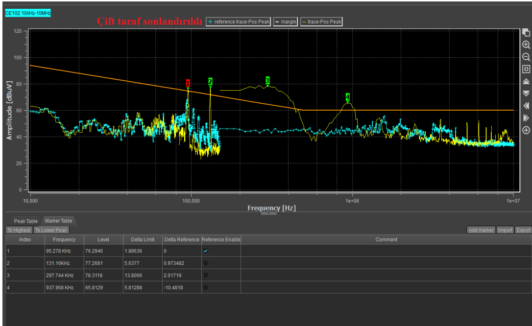
Şekil 3.46. Kablolar ekranlanmış, tek ve çift taraf olarak ayrı ayrı sonlandırılmış ölçüm sonuçları.
