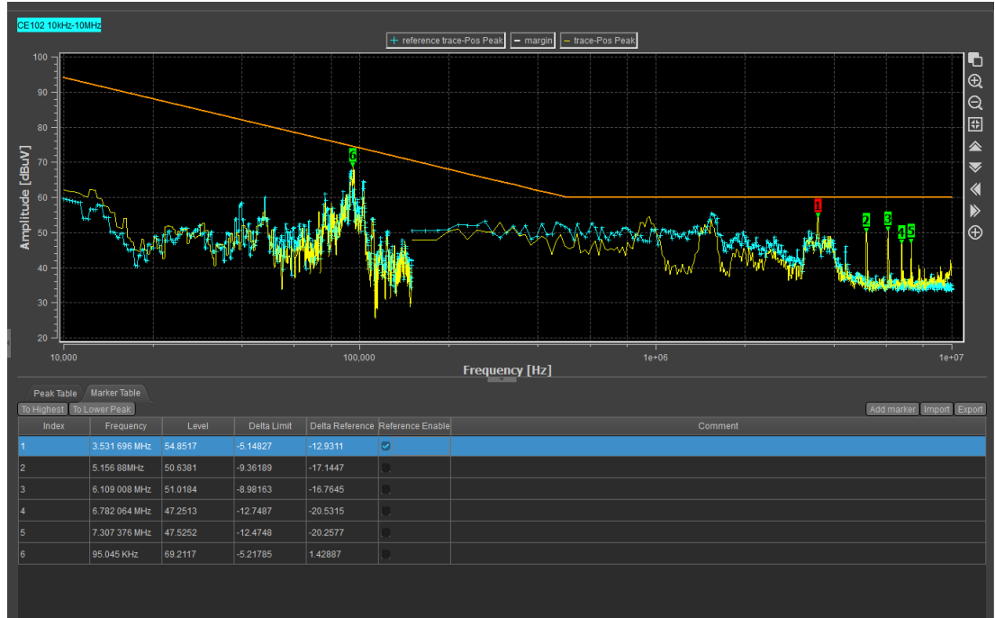
Şekil 3.64. DA modda 4.7 \mu\text{F} ve 6.8 \mu\text{F} değerinde kapasitörler paralel olarak eklendiği durumda ve tam yükteyken alınmış ölçüm sonucu.
