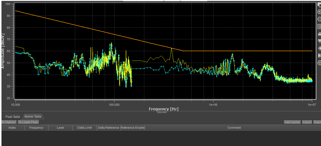
Şekil 3.54. Girişe 1 \mu F kapasitör ve 130 mH CMC eklenmiş ölçüm sonucu.
