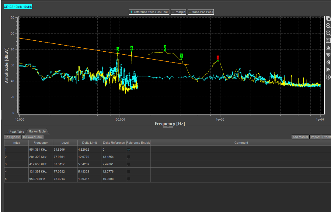
Şekil 3.44. 28 V DA + hattın alınan ölçüm (iki server aktif).
