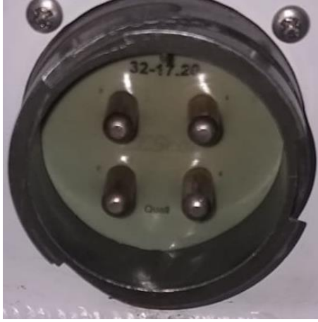
Şekil 3.7. Giriş konnektörüne takılan Quell marka EMI filtre ve yüksek frekansta gürültü zayıflatma etkisi.
