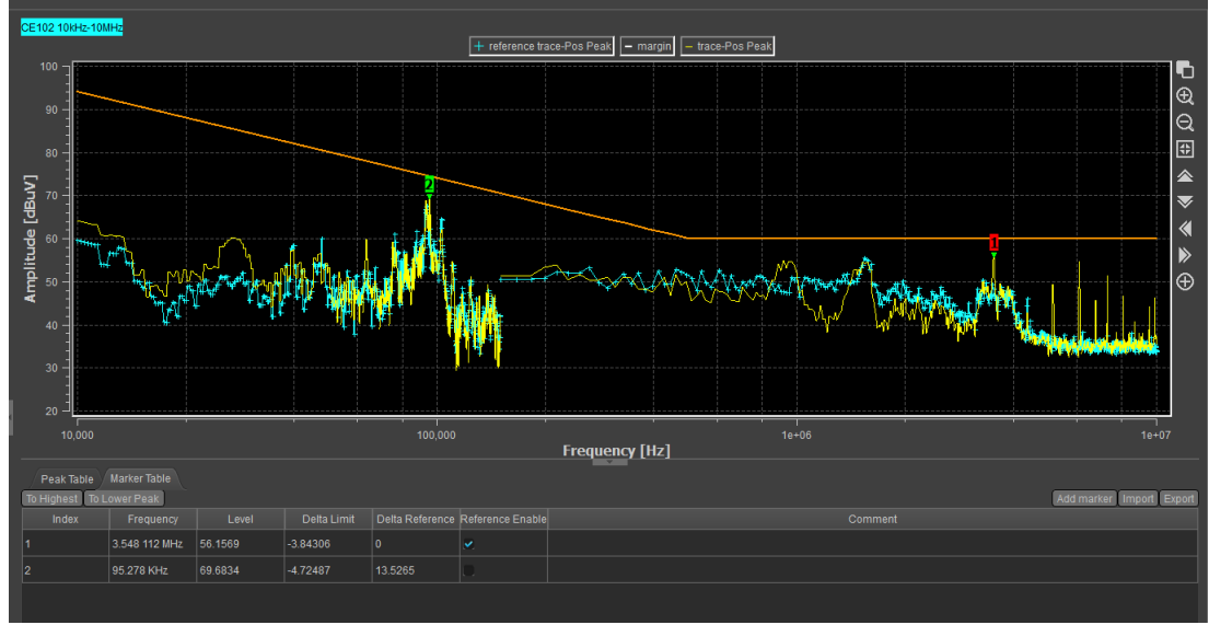
Şekil 3.63. DA modda 4.7 \mu\text{F} ve 6.8 \mu\text{F} değerinde kapasitörler paralel olarak eklenmiş durumdaki ölçüm sonucu.
