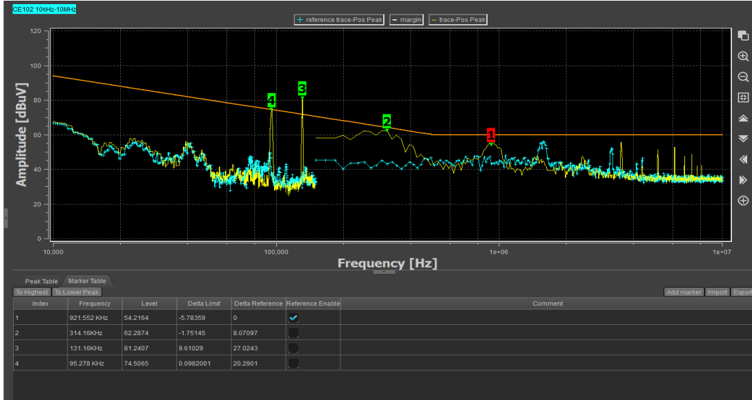
Şekil 3.49. TDK RDEN 4850 DA filtre devreye eklenmiş ve CMC olarak CM8663Z161B-10 kullanılmış durumdaki ölçüm sonucu.
