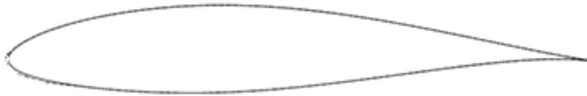
Şekil 3.9. NACA 63-415 kanat profili.
