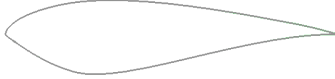
Şekil 3.8. NREL 's S819 kanat profili.
